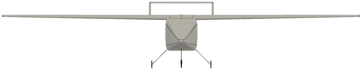
Figura 28: Vista en alzado del tren triciclo fijo
