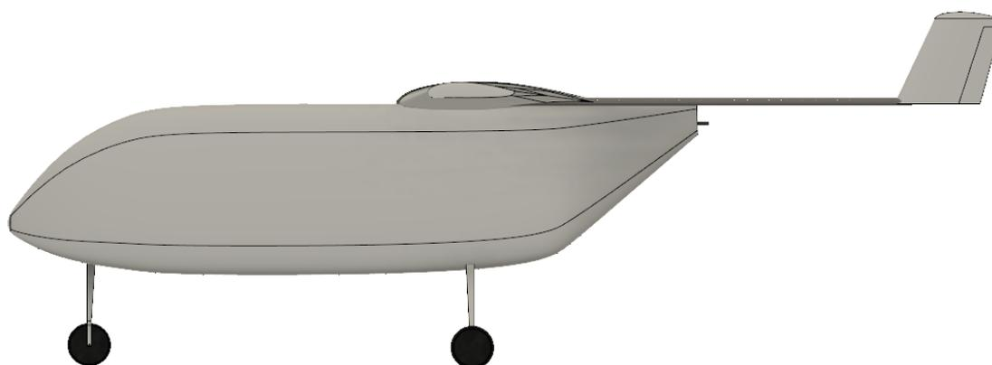
Figura 27: Vista en perfil del tren triciclo fijo
