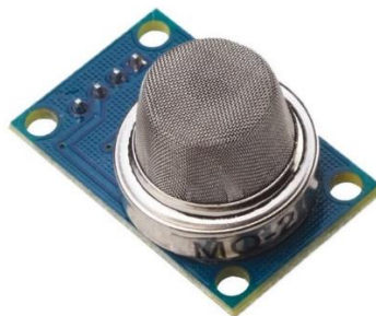
Imagen 28. Detector de gas y humo MQ-2
