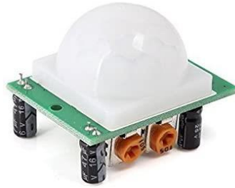
Imagen 24. Sensor de movimiento
