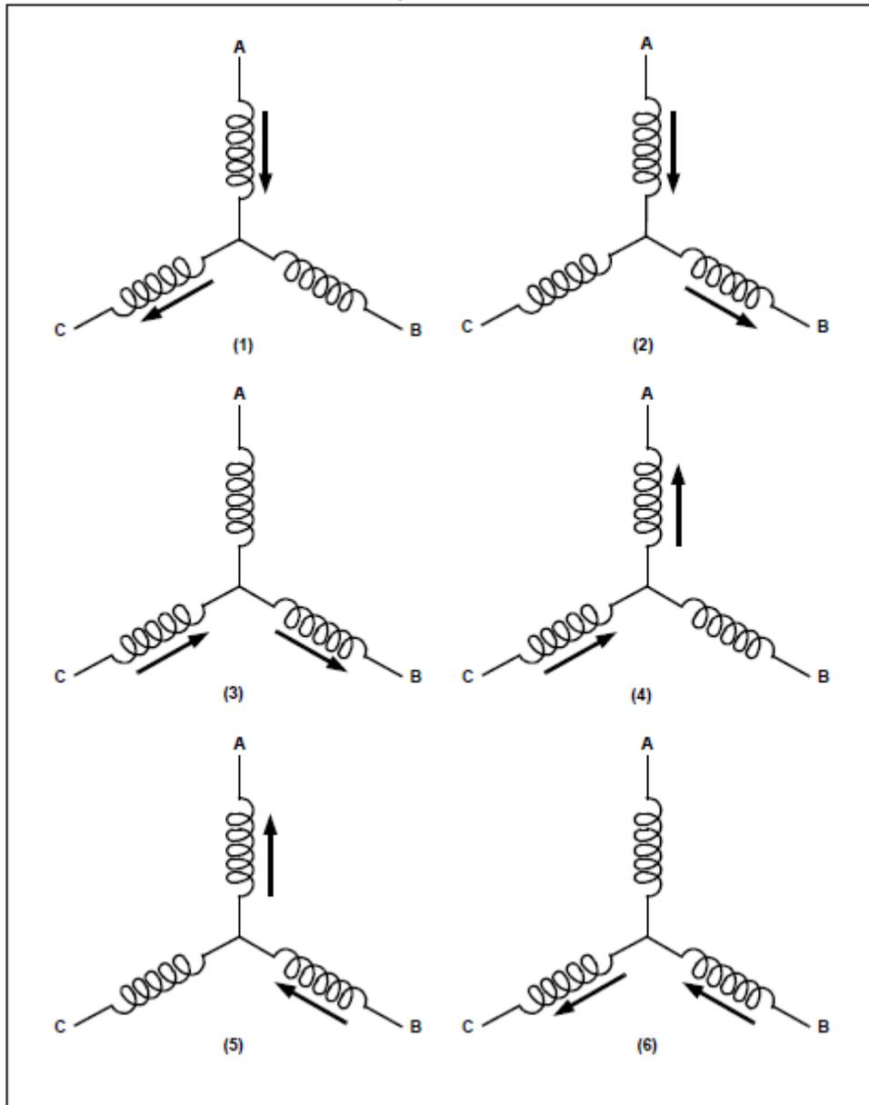
Figura 16: Proceso de conmutación (energización) de los bobinados del motor. Fuente: Microchip.
