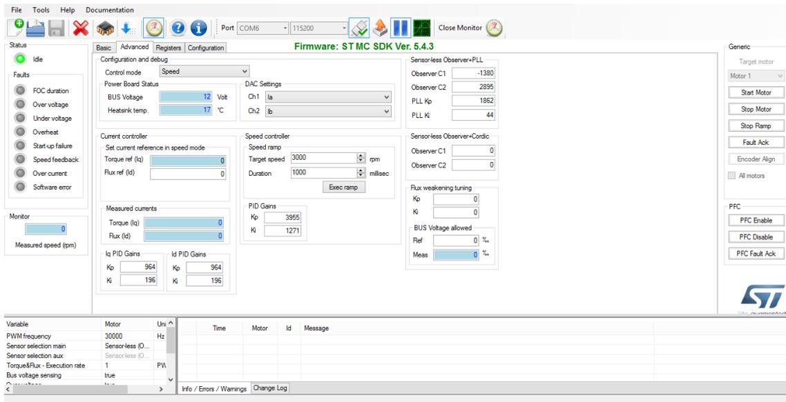
Figura 50: Interfaz avanzada de control del motor. Fuente: ST MC Workbench, Autor.
