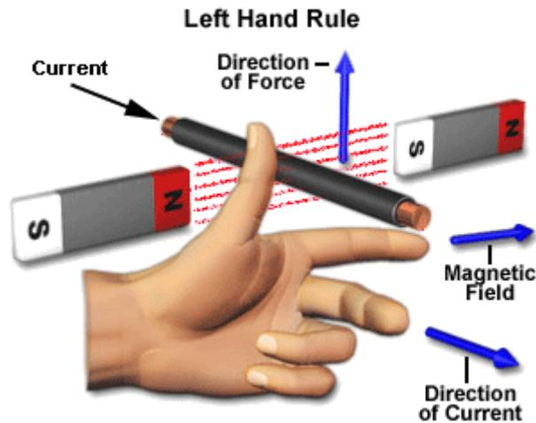
Figura 3: Regla de Fleming de la mano izquierda. Fuente: electrical4you
