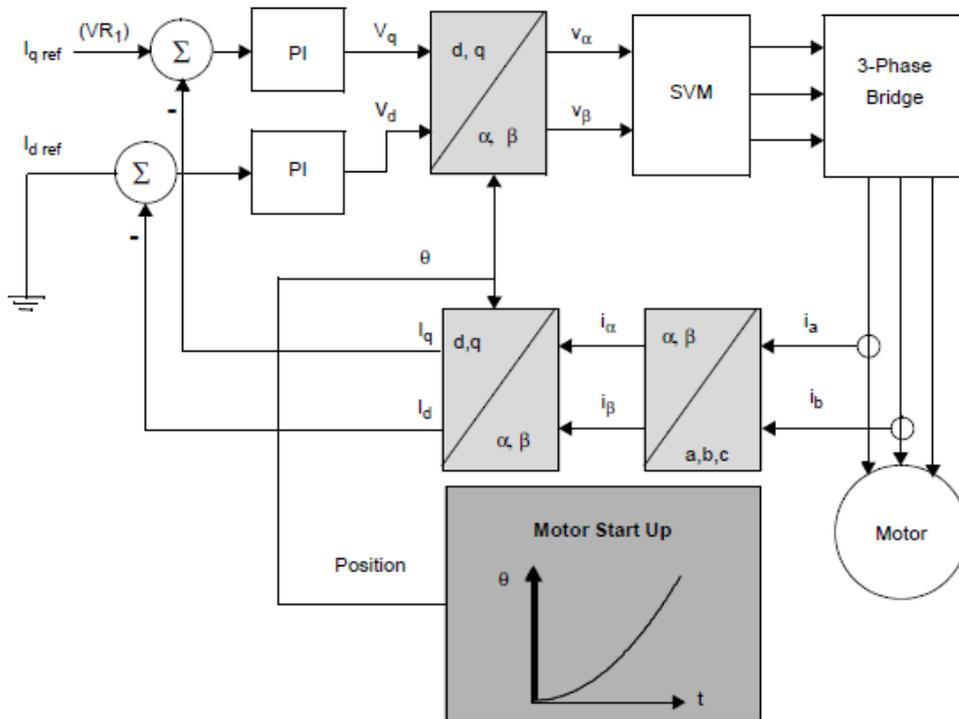
Figura 31: Diagrama de bloques del arranque de un motor PMSM. Fuente: Microchip.
