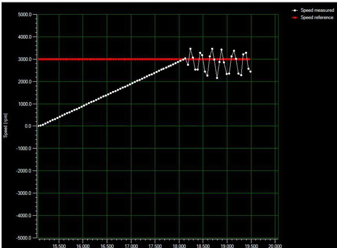
Figura 55: Sobreoscilación producida por un valor muy elevado de  $K_p$ . Fuente: ST MC Workbench, Autor.
