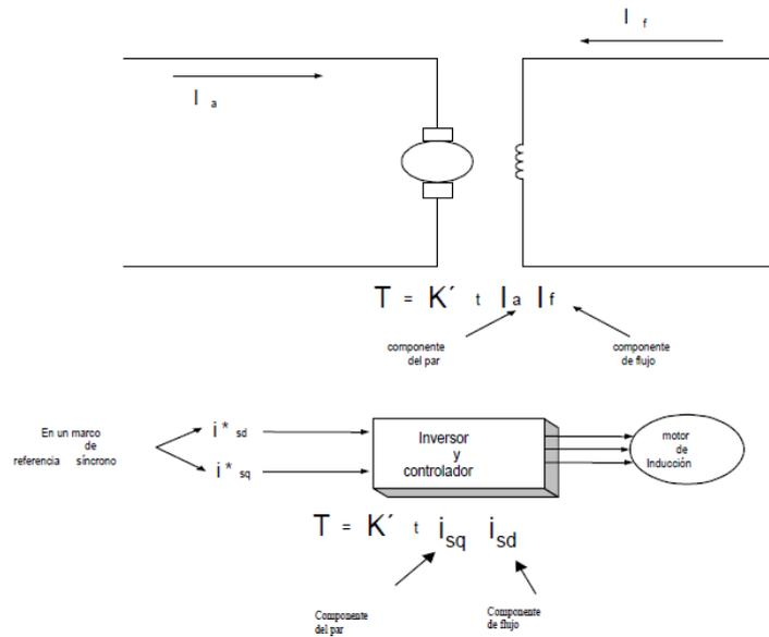
Figura 18: Analogía entre el control de una máquina AC (p.ejem. ACIM) y el control de una máquina DC.<sup>7</sup> Fuente: Máquinas eléctricas: Técnicas modernas de control.
