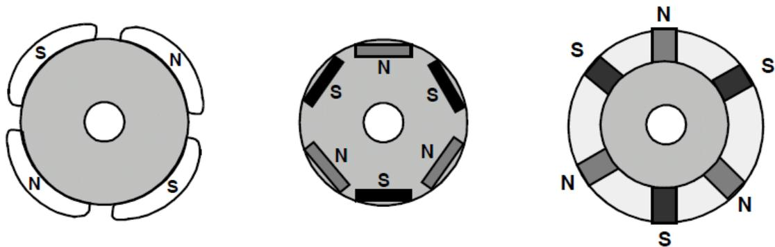
Figura 7: Disposición de los imanes: En superficie, enterrados y encastrados. Fuente: Microchip.
