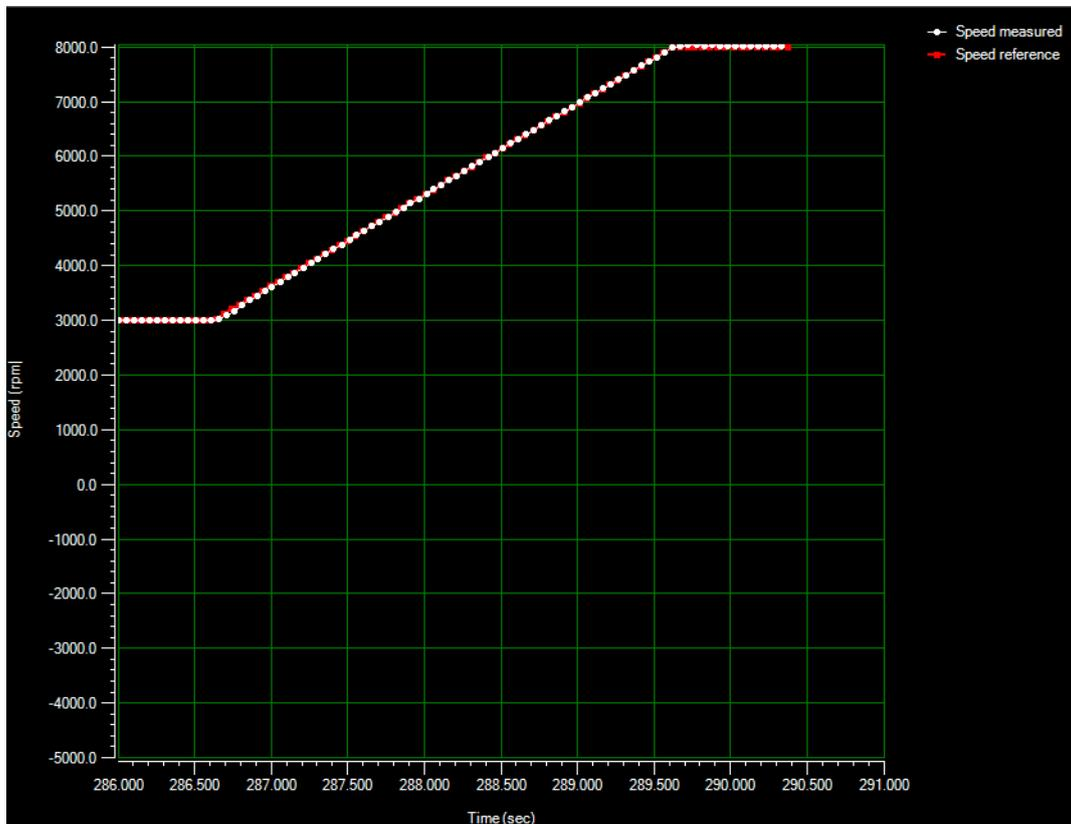
Figura 61: Rampa de aceleración 3. Fuente: ST MC Workbench, Autor.
