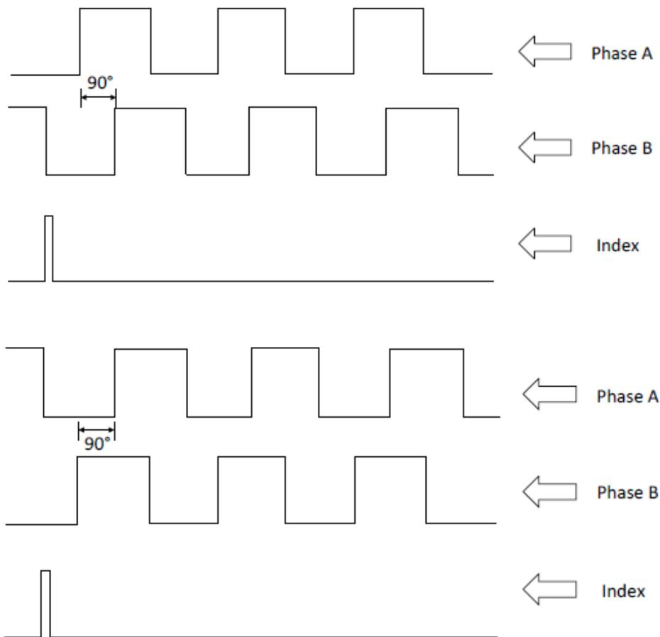
Figura 27: Tren de pulsos generado por el encoder de un motor. Fuente: Microchip.
