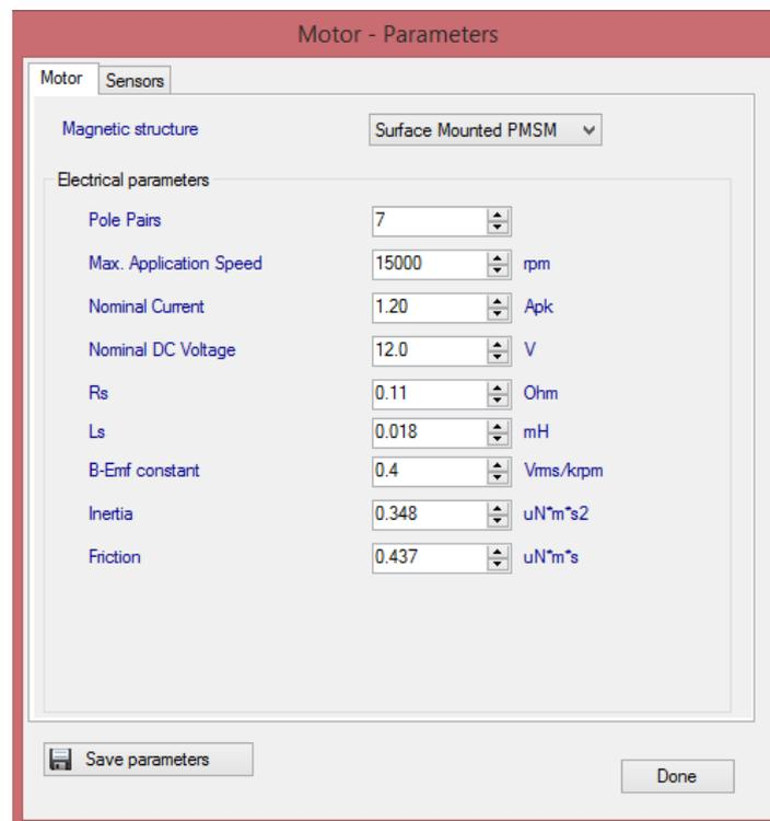
Figura 42: Parámetros del motor. Fuente: ST MC Workbench, Autor.
