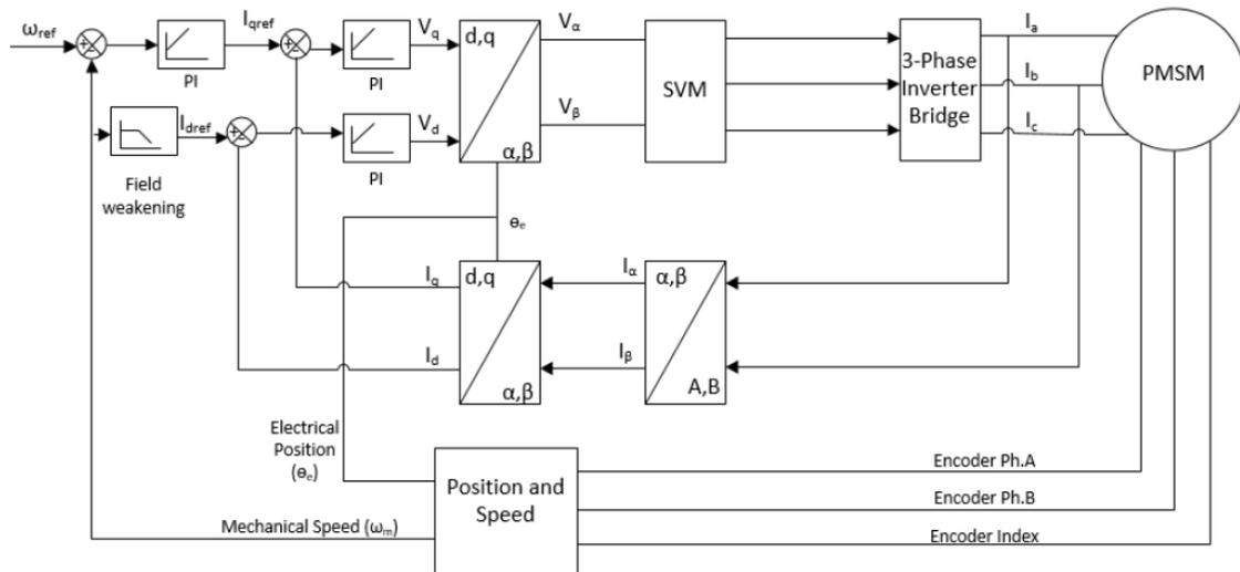
Figura 26: Diagrama de bloques del control FOC con sensores de un PMSM. Fuente: Microchip. (30)
