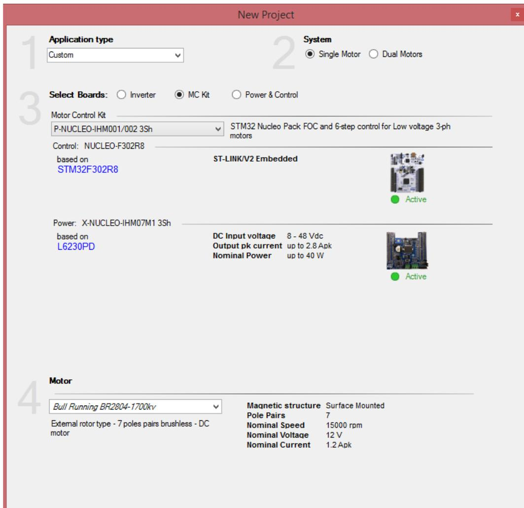
Figura 40: Parámetros de entrada del programa a indicar por el usuario. Fuente: ST MC Workbench, Autor.
