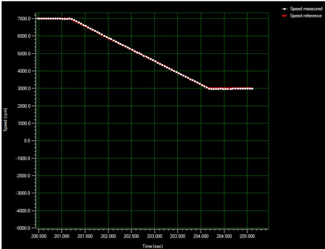
Figura 60: Rampa de deceleración 2. Fuente: ST MC Workbench, Autor.
