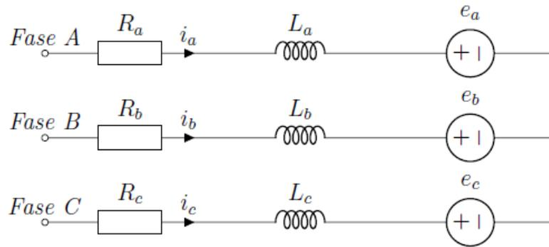
Figura 12: Circuito equivalente motor brushless.
