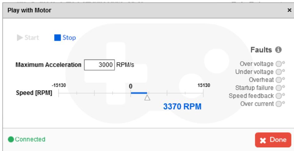
Figura 38: Consola de control integrada en Motor Profiler. Fuente: Motor Profiler, Autor.
