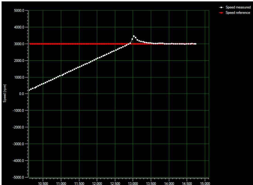
Figura 58: Gráfica de velocidad con  $K_p = 7100$  y  $K_i = 8000$ . Fuente: ST MC Workbench, Autor.
