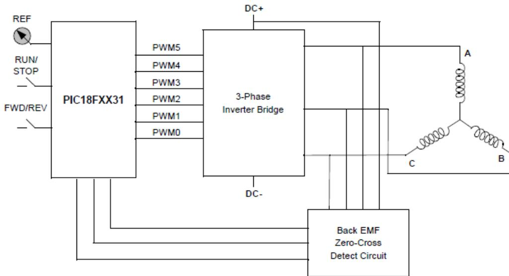
Figura 15: Esquema funcional del circuito ESC. Fuente: Microchip.
