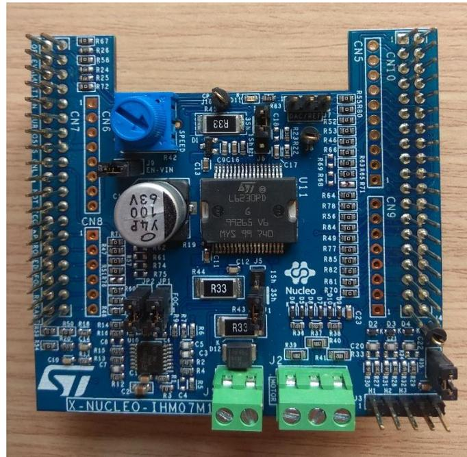
Figura 34: Shield de potencia X-NUCLEO-IHM07M1. Fuente: Archivo del autor.
