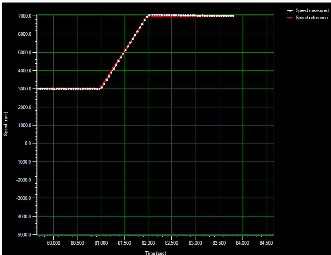
Figura 59: Rampa de aceleración 1. Fuente: ST MC Workbench, Autor.
