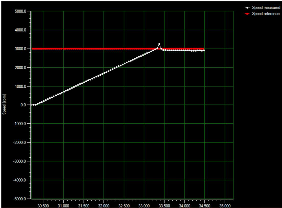
Figura 54: Gráfica de velocidad con  $K_p = 3800$  y  $K_i = 0$ . Fuente: ST MC Workbench, Autor.
