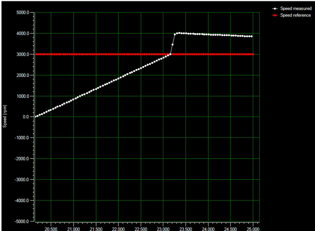
Figura 56: Gráfica de velocidad con  $K_p = 3800$  y  $K_i = 100$ . Fuente: ST MC Workbench, Autor.
