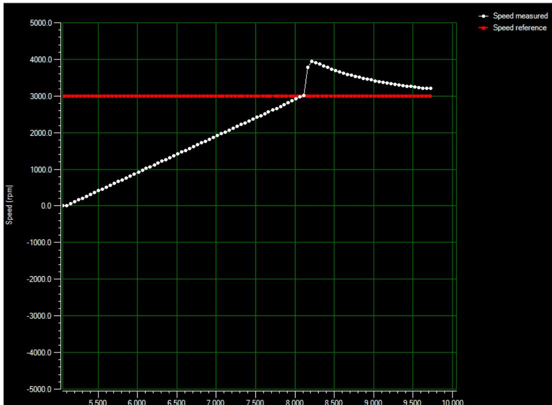
Figura 57: Gráfica de velocidad con  $K_p = 3800$  y  $K_i = 1000$ . Fuente: ST MC Workbench, Autor.
