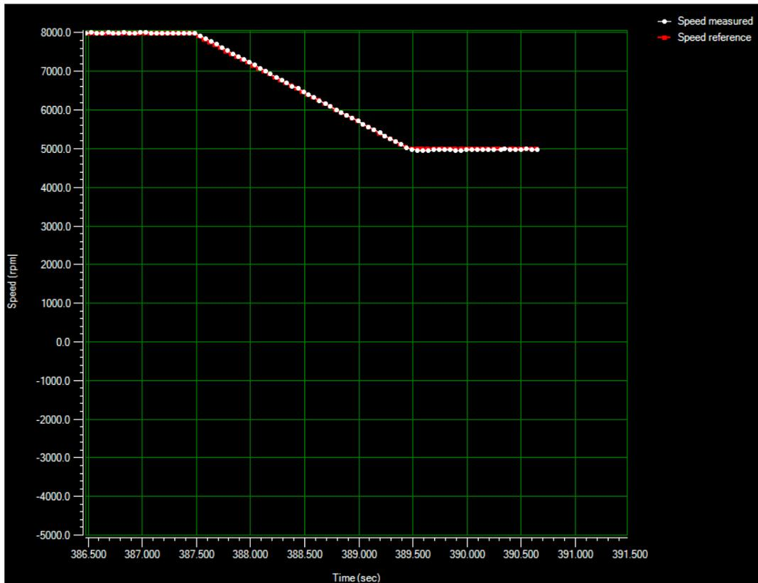
Figura 62: Rampa de deceleración 4. Fuente: ST MC Workbench, Autor.
