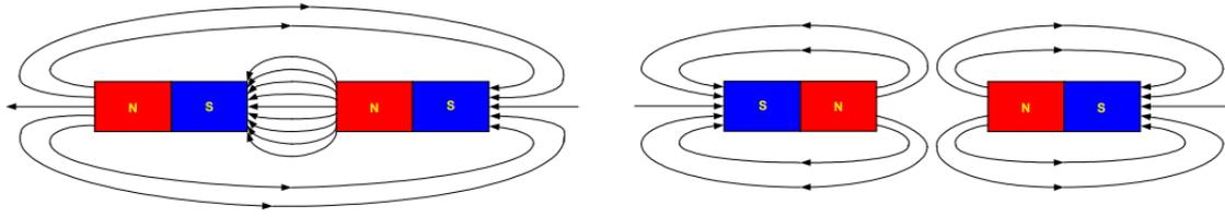
Figura 1: Atracción y repulsión entre polos. Fuente: MonolithicPower.
