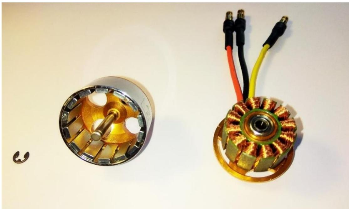
Figura 9: Detalle del estator (derecha) con bobinado concentrado y del rotor (izquierda) de un motor outrunner.
