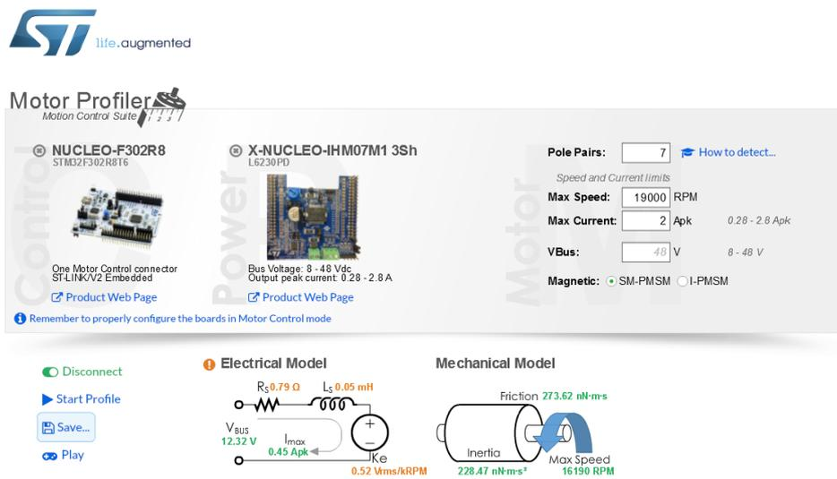
Figura 37: Resultado del ensayo del motor con el Motor Profiler. Fuente: Motor Profiler, Autor.
