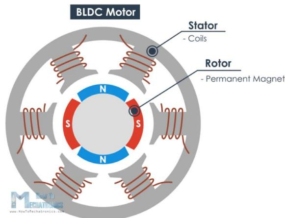
Figura 4: Detalle de las partes del motor BLDC. Fuente: HowToMechatronics.
