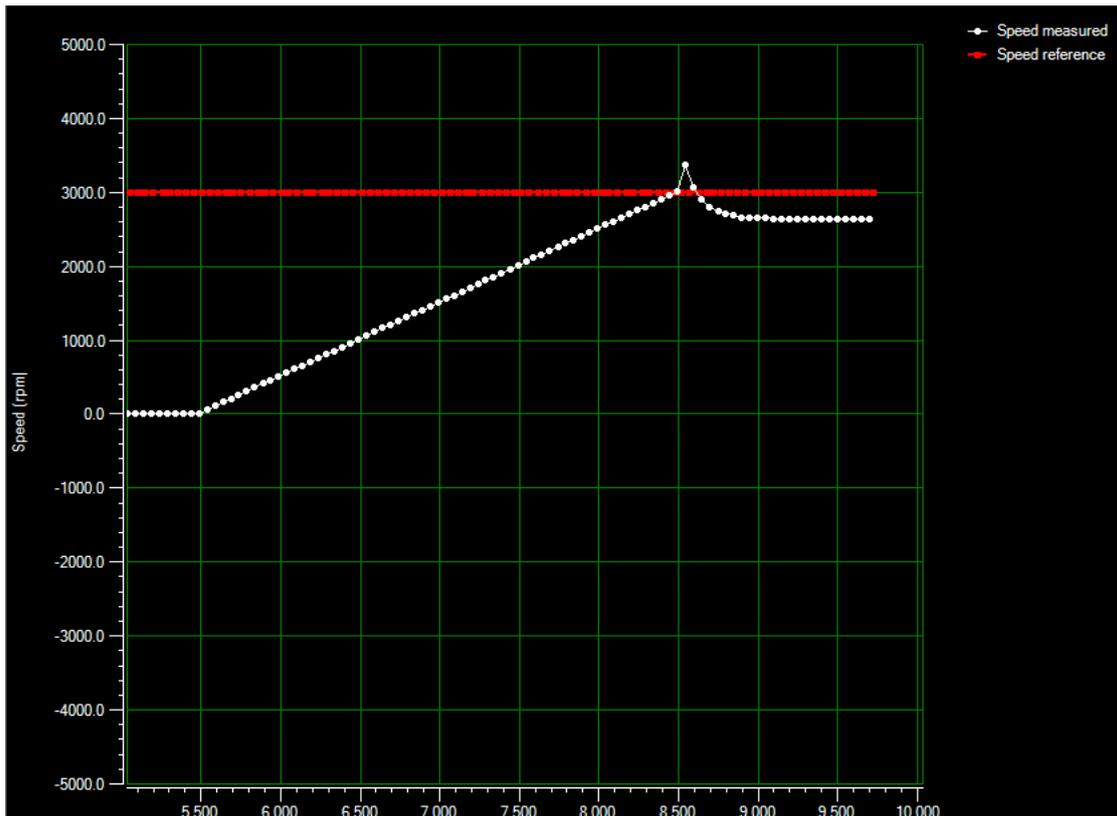
Figura 53: Gráfica de velocidad con  $K_p = 1000$  y  $K_i = 0$ . Fuente: ST MC Workbench, Autor.
