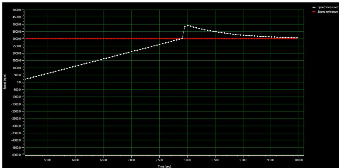
Figura 52: Sobreoscilación en la velocidad del motor. Fuente: ST MC Workbench, Autor.
