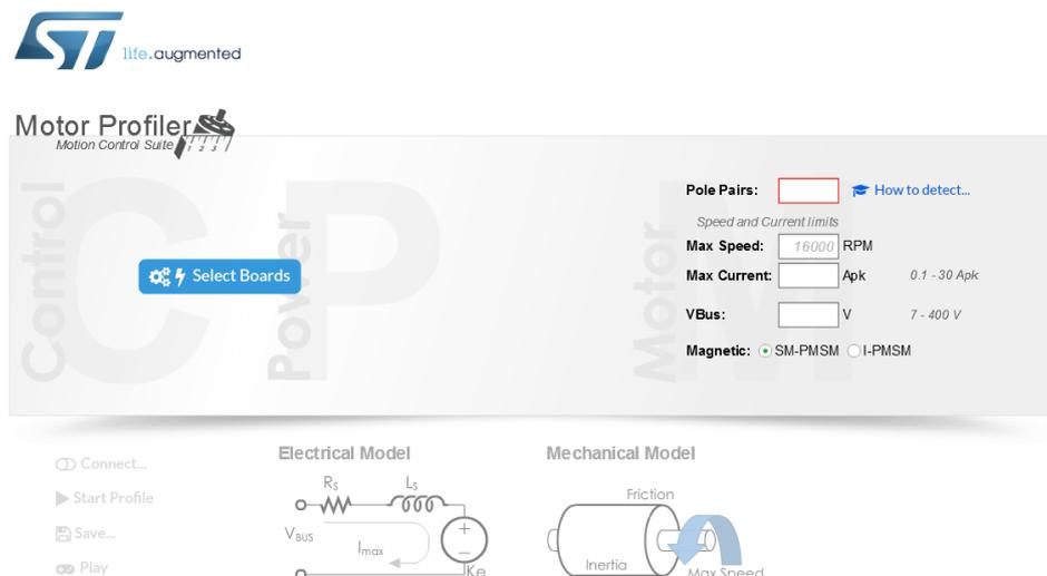
Figura 36: interfaz del programa Motor Profiler. Fuente. Motor Profiler, Autor.
