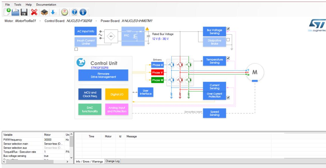
Figura 41: Interfaz principal del programa MC Workbench. Fuente: ST MC Workbench, Autor.
