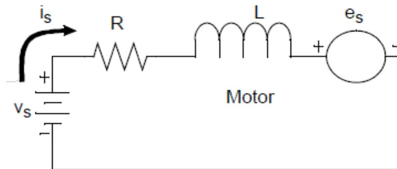
Figura 28: Modelo del motor BLDC. Fuente: Microchip.
