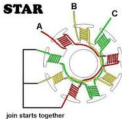
Figura 5: Configuración en estrella (Star) de los bobinados de un motor. Fuente: e-radiocontrol.com.
