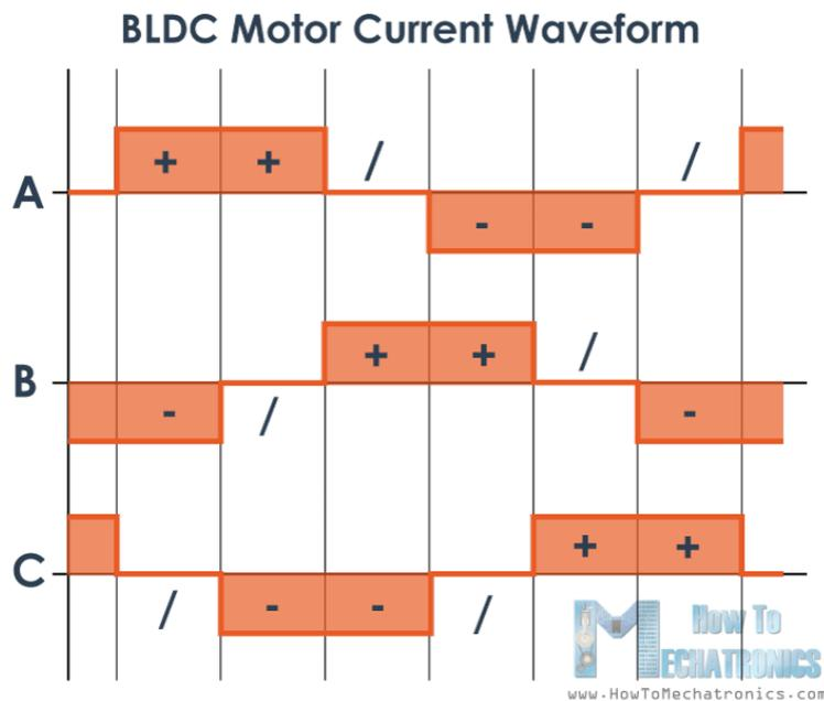
Figura 14: Conmutación de los MOSFET en un motor BLDC. Fuente: HowToMechatronics.
