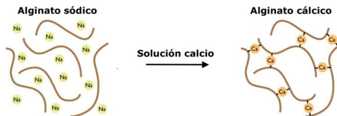
**Figura 3.** Esquema del proceso de entrecruzamiento iónico entre los cationes de  $\text{Ca}^{2+}$  y dos polímeros de alginato a través de los residuos de  $\alpha$ -L-glucurónico. (Figura adaptada a partir de "Chemical Bonds Using Polymers To Understand Chemical Bonds", 2020).
