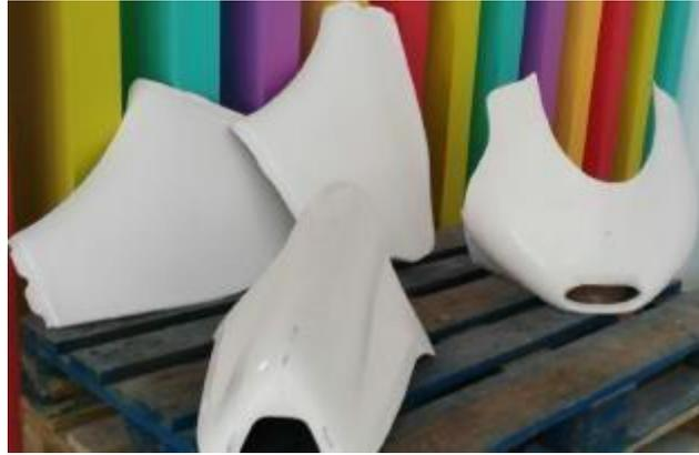
Imagen A1.4.26 Acabado exterior gelcoat carenados de yute
