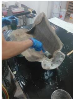
Imagen A1.4.24 Aplicación capas sucesivas fibra vegetal y bioresina sobre molde.
