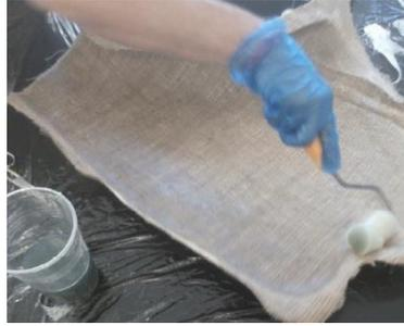
Imagen A1.4.23 Aplicación bioresina sobre fibra vegetal en molde 1ªcapa
