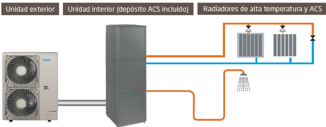
**Figura 30: Sistema de aerotermia**
