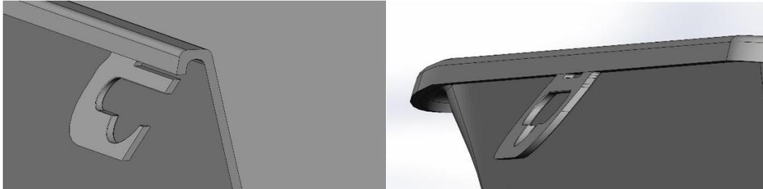
*Figura 37. Colgador perpendicular a la dirección de apertura*
