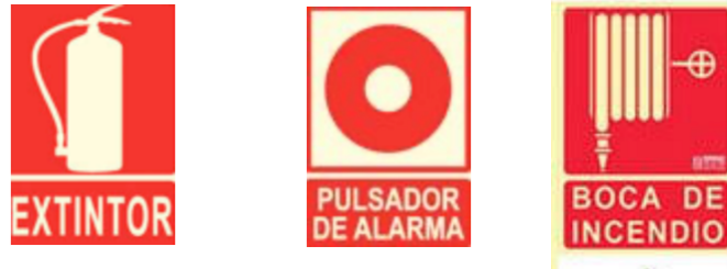
FIGURA 25. SEÑALES EQUIPOS DE LUCHA CONTRA INCENDIOS. (FUENTE: HTTPS://WWW.RUVASEGURIDAD.COM/BLOG/SENALES-EN-CASO-DE-INCENDIOS/INDEX.HTML )
