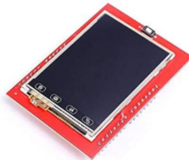
**Figura 3.20:** *Modelo 3 de pantalla TFT LCD.*
