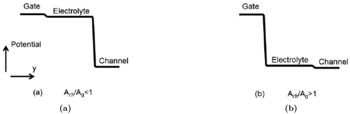
**Figura 1.11:** *Distribución de potencial entre el electrodo de puerta y el canal para dos geometrías [Yaghmazadeh et al., 2011].*
