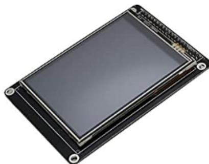
**Figura 3.18:** Modelo 1 de pantalla TFT LCD.
