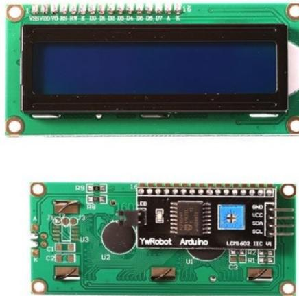
**Figura 3.23:** *Display LCD con módulo I2C incorporado.*
