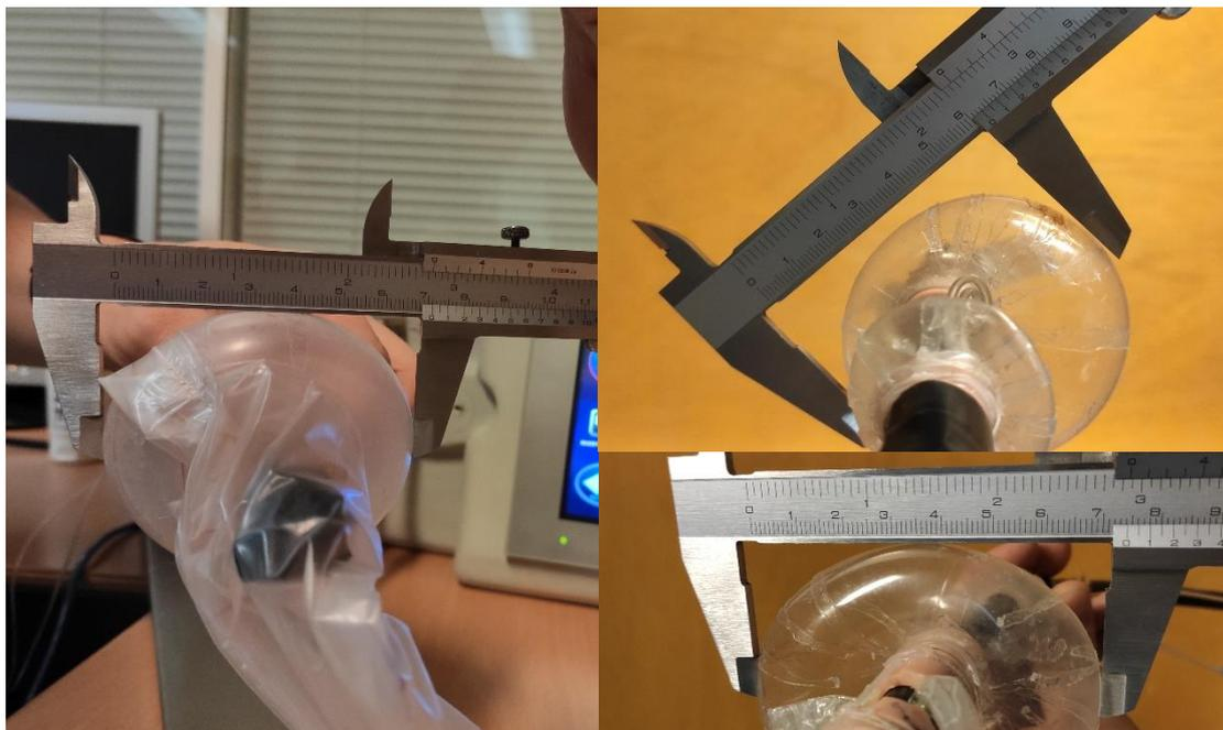
Fig. 22. Medida de diámetro de CER en ensayos de fuerza. A la derecha se representan medidas fuera del modelo intestinal, mientras que a la izquierda se representa una medida que supera el máximo deseado en el interior del modelo intestinal.
