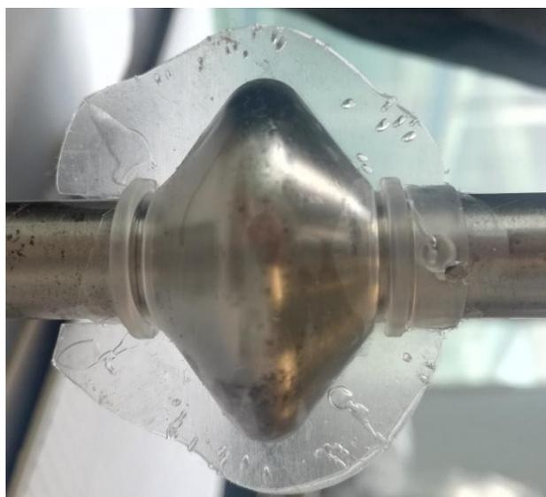
Fig. 9. CER recién fabricada sin extraer del husillo. En los laterales se aprecia un exceso de silicona, que se elimina posteriormente.
