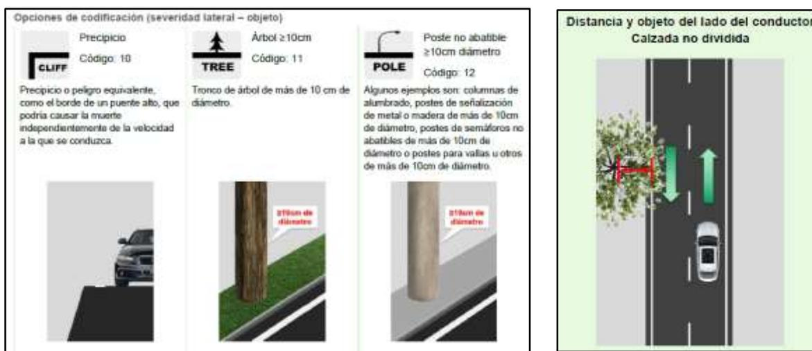
Figura 40. Codificación Severidad y Distancia Lateral
