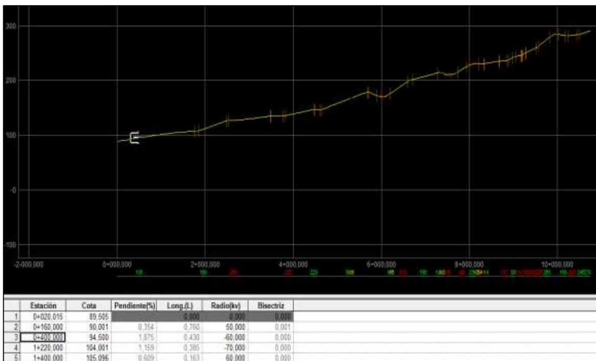
Figura 8. Restitución del Trazado en Alzado
