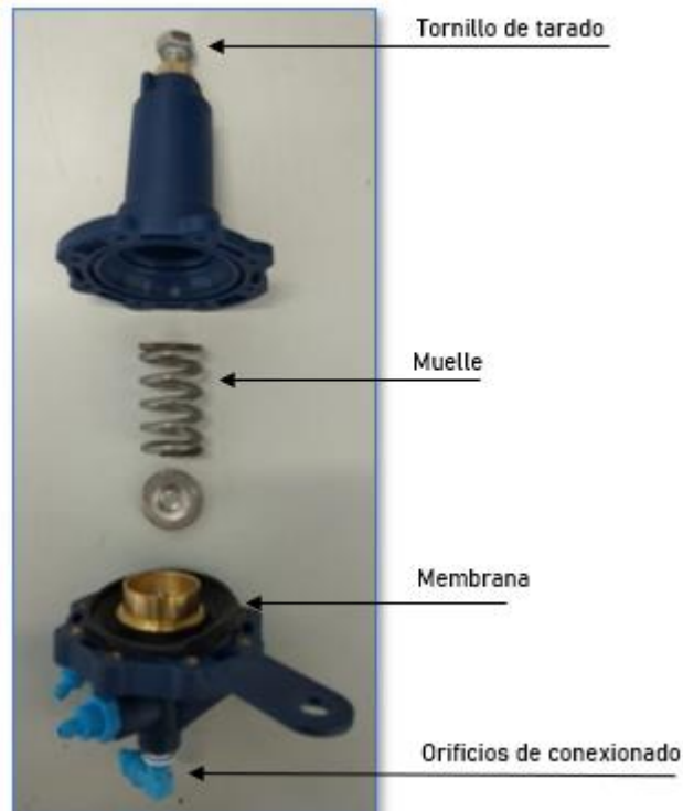
Ilustración 7: Partes del piloto de 3 vías conectado a la válvula
