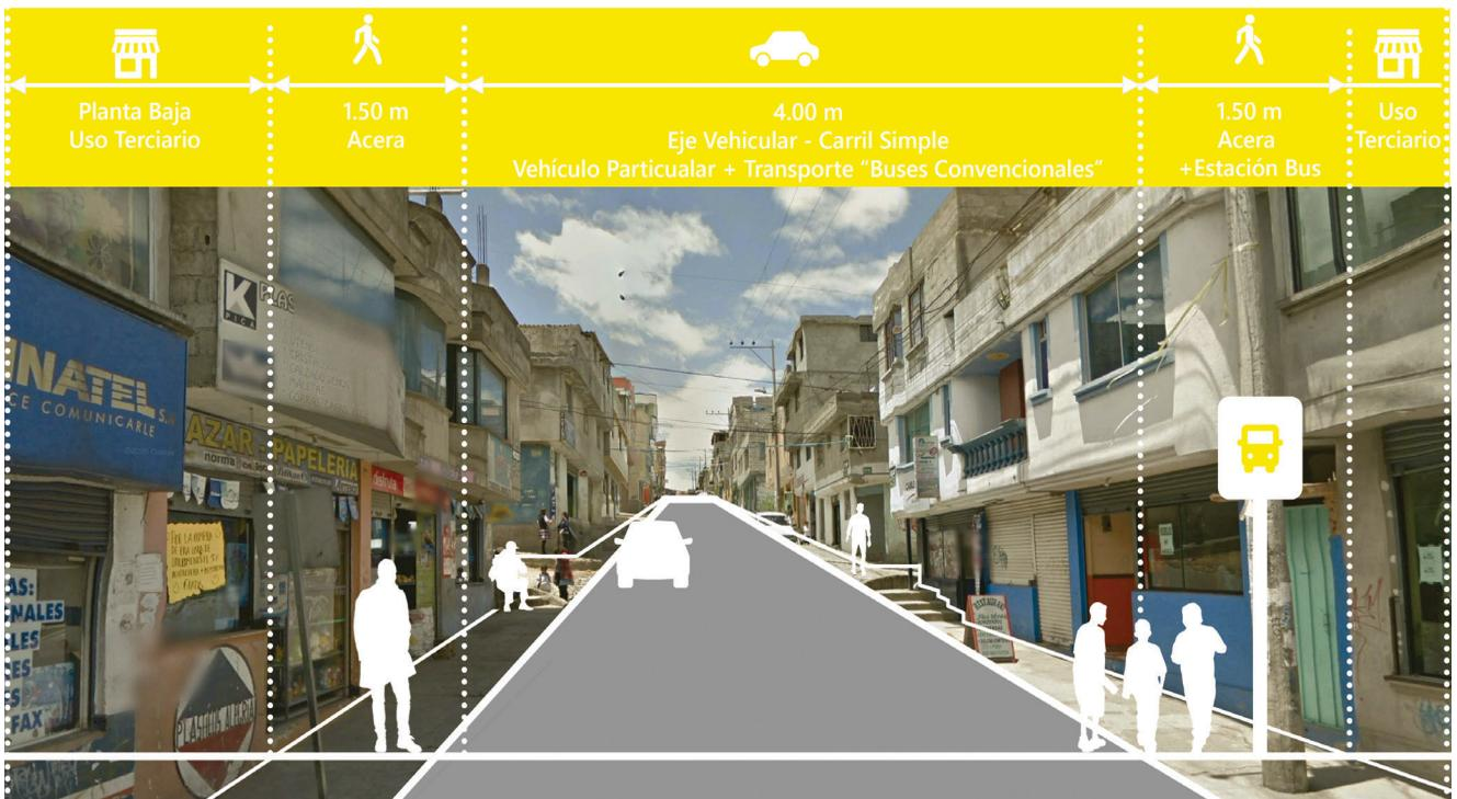
Figura 17: Corte Esquemático B-B' - Eje Principal
