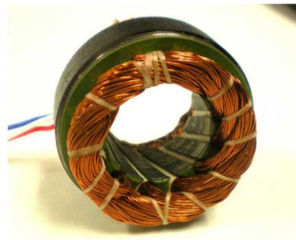
Figura 14: Diferencia entre un bobinado concentrado (motor brushless) y un bobinado distribuido (PMSM).
