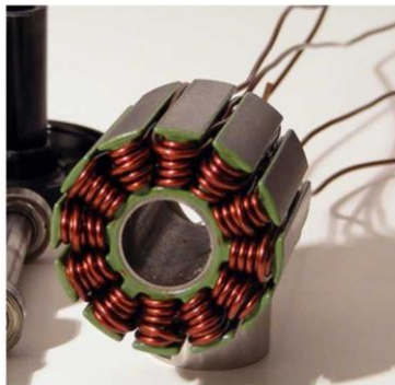
Figura 14: Diferencia entre un bobinado concentrado (motor brushless) y un bobinado distribuido (PMSM).
