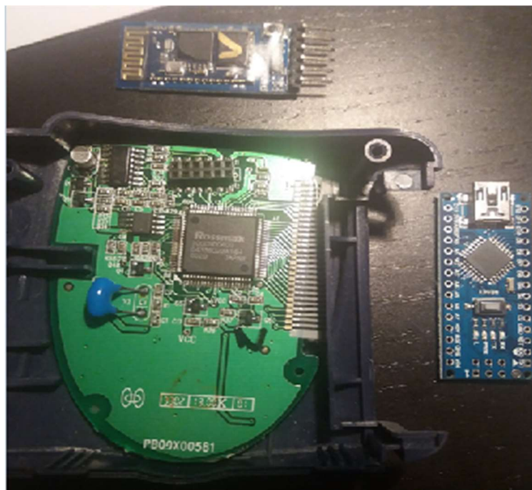
Figura 50 Comparación de tamaño entre circuito de control, Arduino NANO y modulo Bluetooth.
