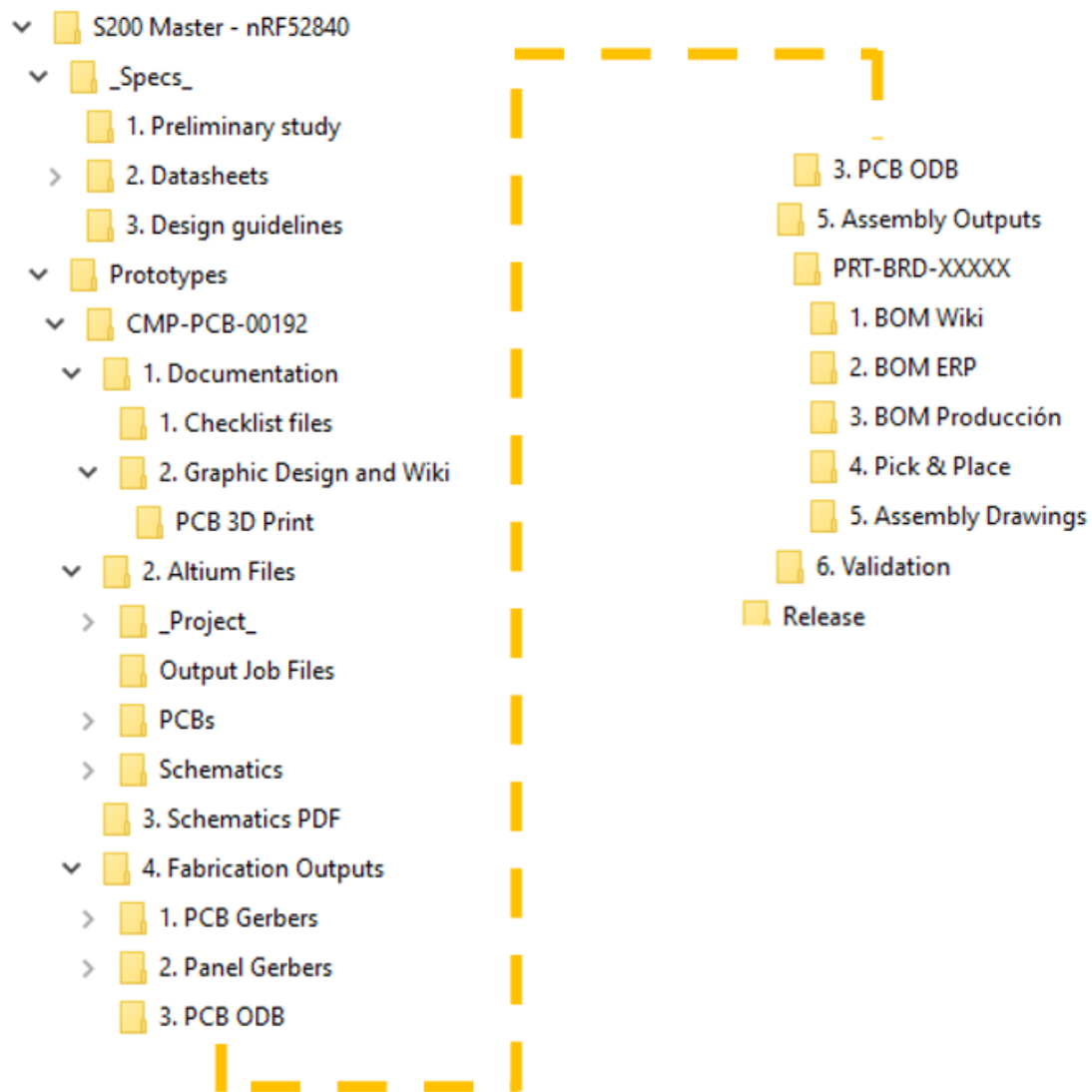
Figura 10. Estructura de directorios para un proyecto de Rhomb. La línea discontinua indica que los directorios de la derecha seguirían después de la carpeta “3.PCB ODB”.
