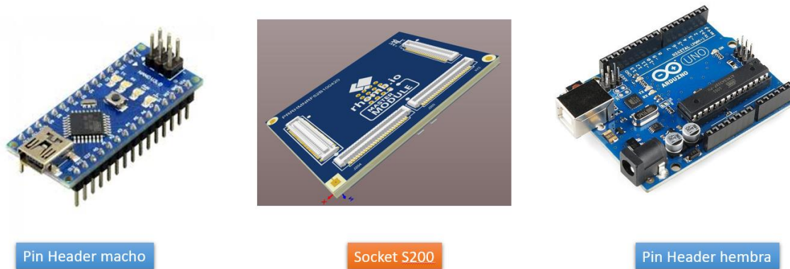
Figura 30. Comparativa de formatos de conexión. Arduino Nano (izquierda), máster nRF52840 de Rhomb (centro) y Arduino UNO (derecha).
