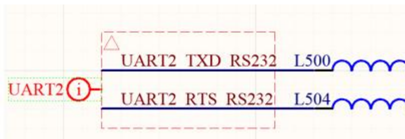
Figura 19. Net class UART2. El recuadro de líneas discontinuas es empleado por Altium para indicar qué señales forman parte del grupo. El triángulo de la esquina superior izquierda es un botón para desplegar la información relacionada con la net class.
