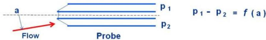
Figura 1.3: Método de la NASA para obtener el ángulo de ataque
