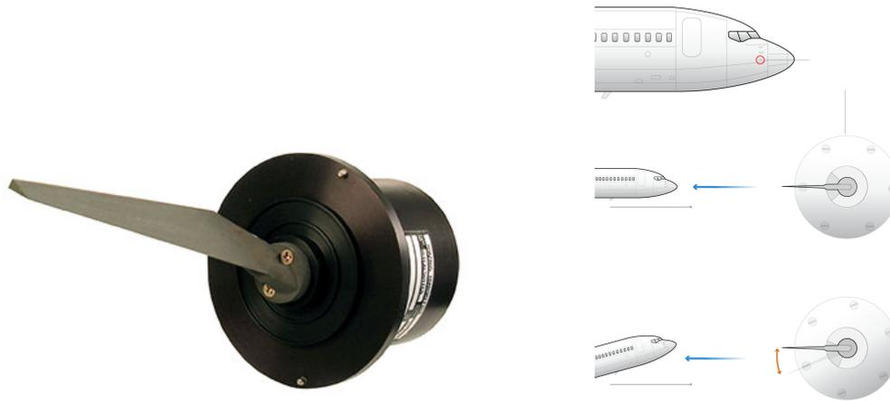
Figura 1.6: Sensor real del ángulo de ataque de una aeronave comercial y su localización en el fuselaje
