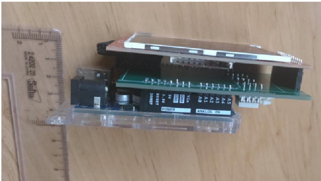
Figura 2.18: Dimensión del sistema montado sobre la PCB
