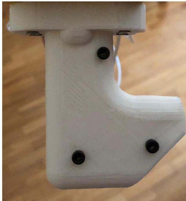
Figura 2.23: Pieza impresa en 3D y sellada con los tubos de silicona en su interior
