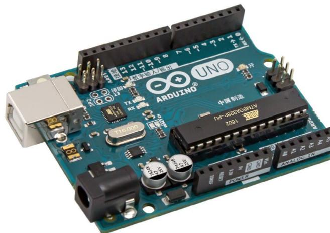
Figura 2.2: Placa Arduino UNO Rev3
