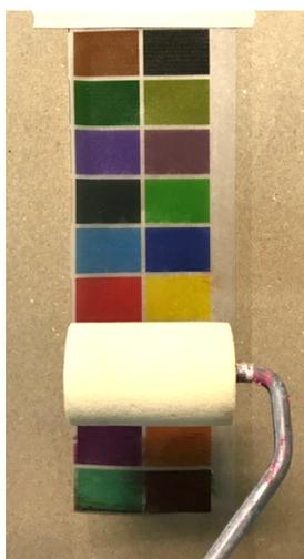
**Fig. 30.** Aplicación del adhesivo Wunda Size Synthetic Gold Size con ayuda de un rodillo de espuma
