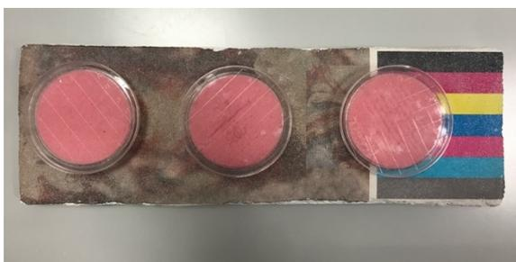
**Fig. 51.** Medición del índice de absorción de la probeta B.5 mediante el kit de esponjas de contacto de C.T.S.
