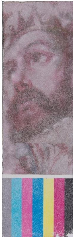
**Fig. 60.** PROBETA B.4 después del ensayo de envejecimiento acelerado
