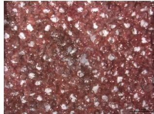
**Fig. 50.** Detalle con lupa binocular de la Probeta B.2 en la que se aprecia la separación forzada
