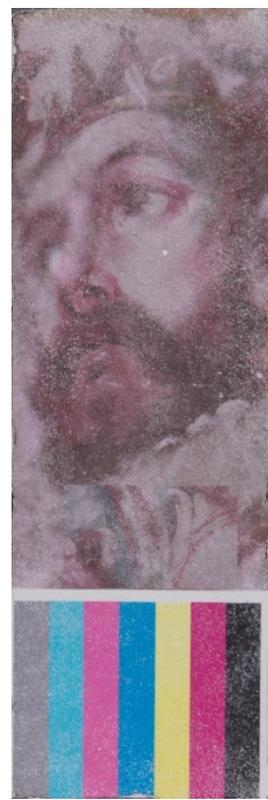
**Fig. 62.** PROBETA B.5 después del ensayo de envejecimiento acelerado
