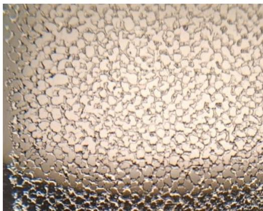
Fig. 41. Aplicación del adhesivo mediante una trama tradicional de puntos regulares del 70%
