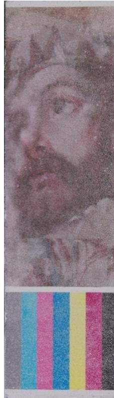
**Fig. 58.** PROBETA B.3 después del ensayo de envejecimiento acelerado
