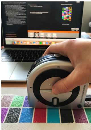
Fig. 26. Medición del target mediante el espectrofotómetro X-Rite i1Studio
