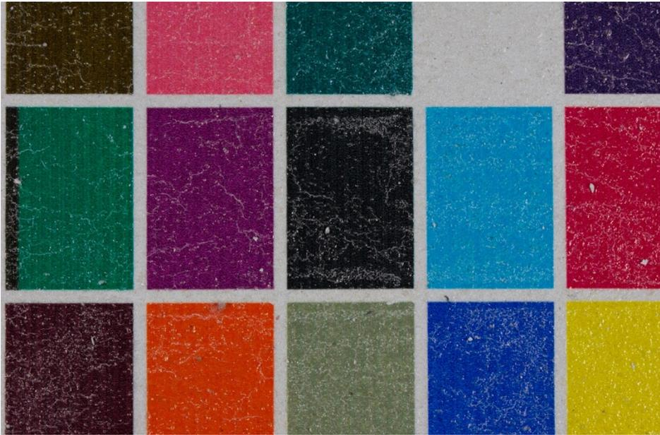
**Fig. 36.** Detalle de la PROBETA A.4. Mediante observación macroscópica se aprecian craqueladuras y puntos sin tinta
