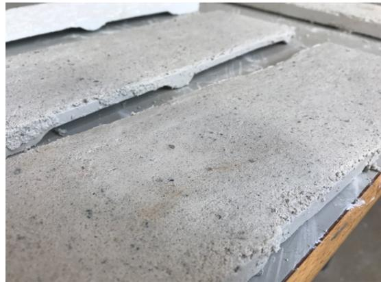
**Fig. 22.** Enlucido de las probetas de yeso con un mortero de reintegración de pintura mural
