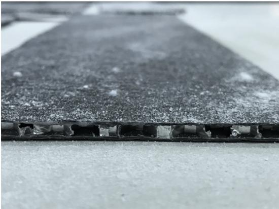
**Fig. 21.** Preparación de la superficie de las probetas de fibra de carbono. Aplicación de Plextol® B500 y gravilla fina.
