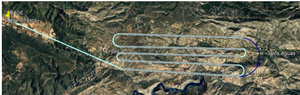
Figura 16: Ruta de reconocimiento del drone Repetidor.
