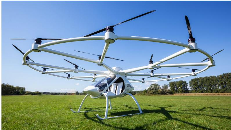
**Figura 2.2:** Multicóptero a escala completa: VC200
