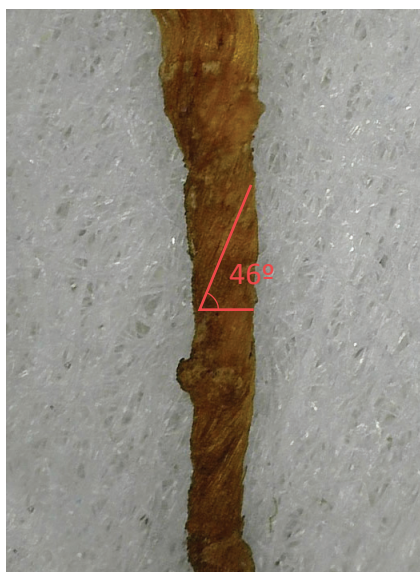
Fig. 28. Detalle del grado de torsión de un hilo. Dino-Lite Special lighting (56 x) .
