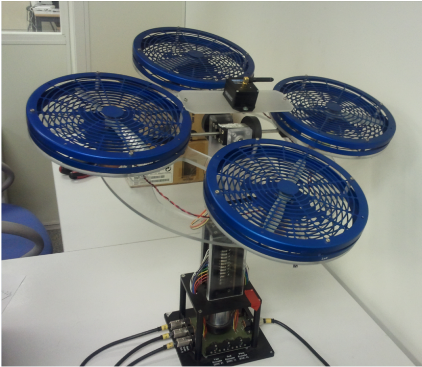
Figura 7.1. Sistema de cuatro rotores con la unidad de medida inalámbrica integrada (IMU).
