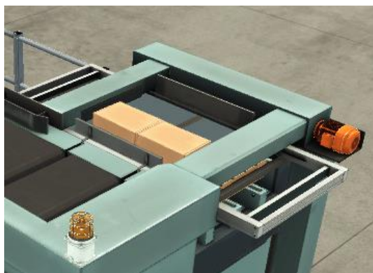
Imagen 26. Primer lote cargado cajas no giradas
