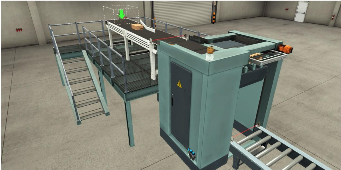
Imagen 23. Ascensor arriba y comienza a entrar cajas por la cinta transportadora
