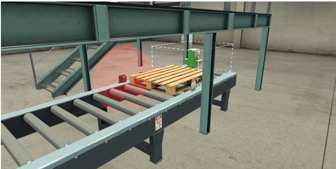
Imagen 20. RFID 1 leyendo el tipo de palé
