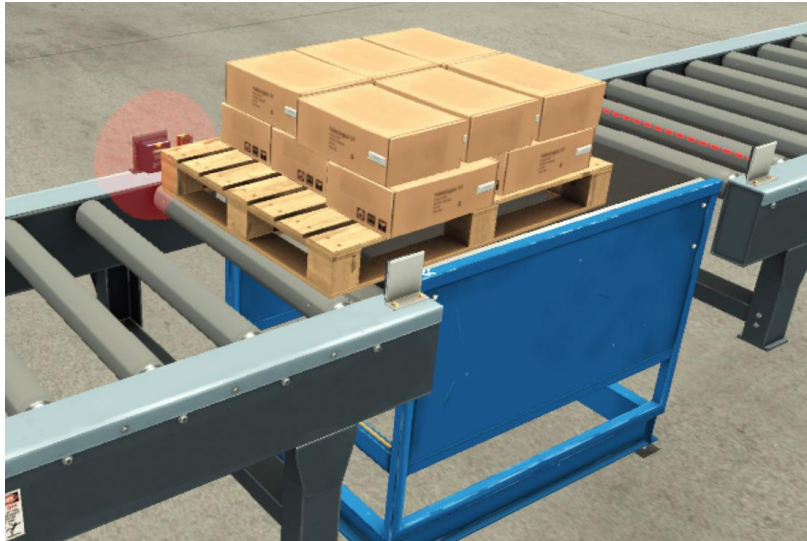
Imagen 38. RFID 2 escribiendo en la etiqueta de RFID del palé
