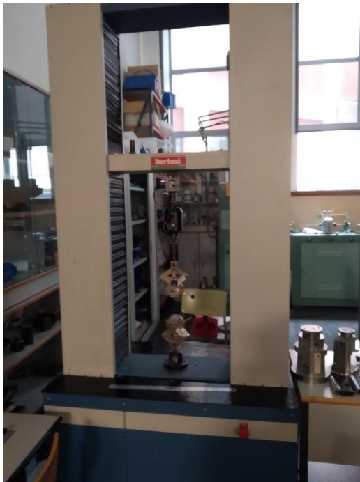
Figura 28. Máquina utilizada para los ensayos de tracción y flexión.
