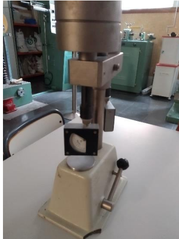
Figura 29. Durómetro utilizado para realizar las medidas de dureza.
