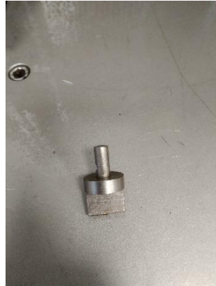
Figura 23. Punzón utilizado para realizar los ensayos de HDT.
