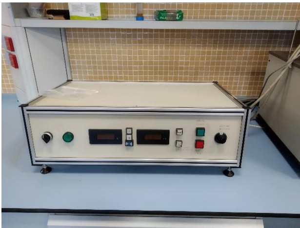
Figura 24. Máquina utilizada para realizar los ensayos de VICAT/HDT.
