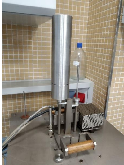
Figura 21. VICAT con el peso correspondiente por la normativa 5 kg.
