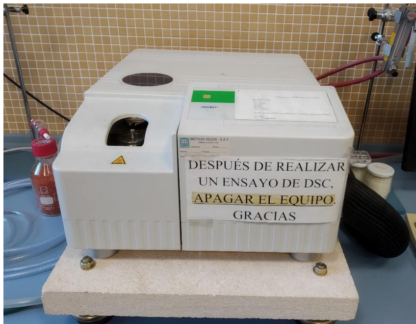
Figura 20. Máquina de calorimetría diferencial de barrido.
