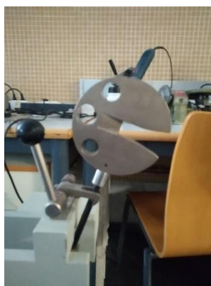
Figura 30. Péndulo de 6J utilizado en el ensayo a impacto.
