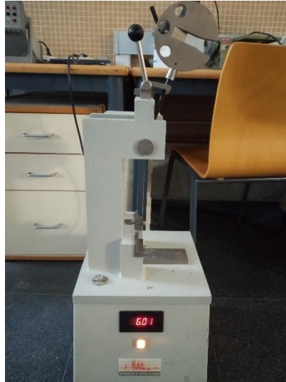
Figura 31. Máquina utilizada para medir la resistencia a impacto con un péndulo de 6J.
