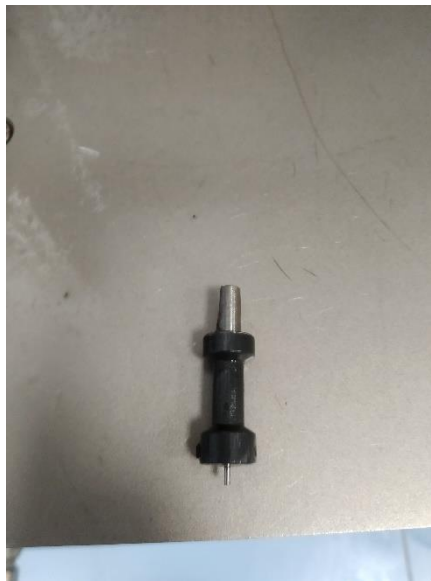
Figura 22. Punzón utilizado para realizar los ensayos de VICAT.
