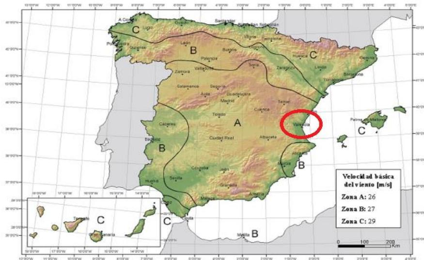
Figura AN.1 – Mapa de isotacas de la velocidad básica fundamental del viento  $v_{b,0}$
