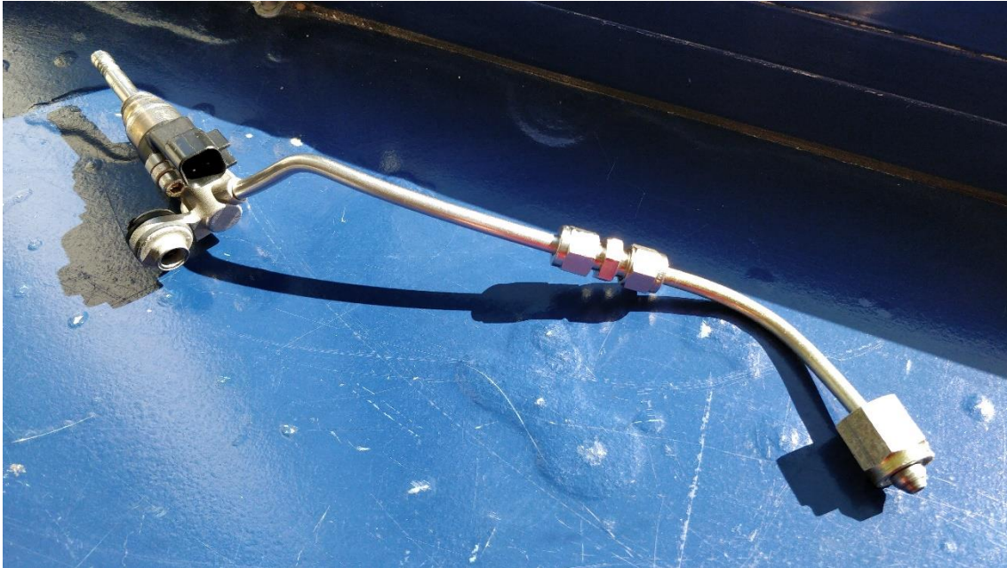
55. Detalle del inyector con el conducto de unión al segundo Common rail. también se observa la conexión eléctrica del regulador del inyector. Fuente: Centro de Motores Térmicos (03/03/2020).
