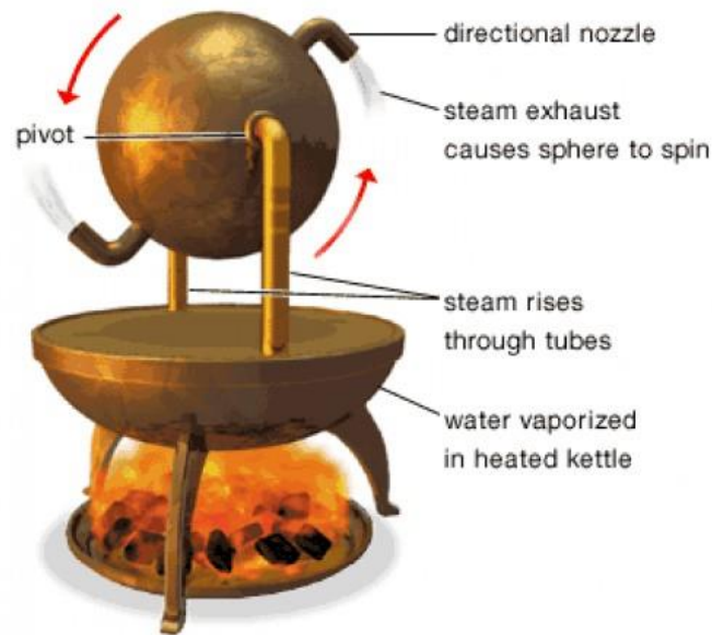
8. Máquina de Herón de Alejandría. Año 120 a.C. Se considera la primera invención de máquina de vapor antigua y base fundamental de lo que se conoce hoy a la rama de la ciencia y de la ingeniería dedicada a turbo maquinaria. Fuente: [30].
