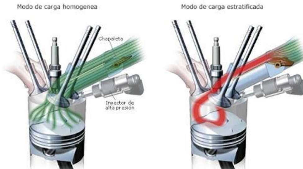
18. Representación de los modos de carga para el sistema GDI en situación de plena carga para el caso de carga homogénea (Izquierda) y a carga parcial para carga estratificada (Derecha). Fuente: [37].
