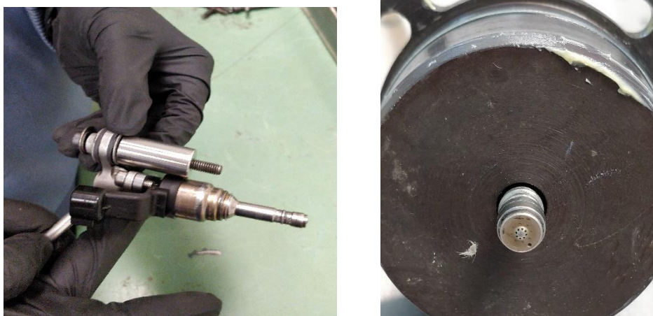
21. Inyector tipo solenoide de estudio. imagen de perfil (izquierda), imagen de frontal donde se puede visualizar el número de agujeros (derecha). Fuente: Elaboración propia en el Centro de motores Térmicos (CMT).
