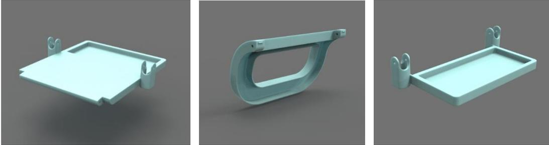
Figuras 55, 56 y 57: Bandeja inferior, pata y bandeja superior.
