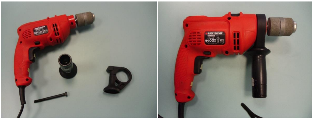
Figura 11 Muestra el desmontaje del mango del taladro
