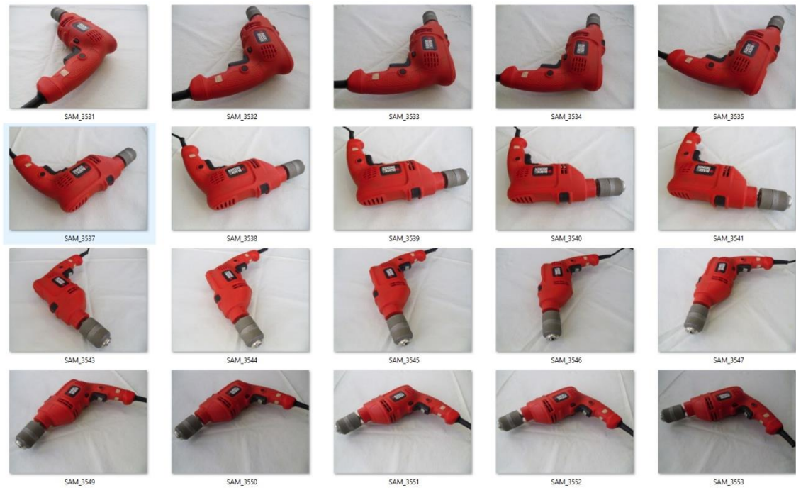
Figura 12 Muestra de las imágenes tomadas para hacer el digitalizado 3D mediante fotogrametría
