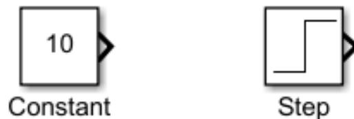
Figura 1.5.2.1. bloques de valor constante y de función de paso respectivamente.
