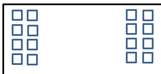
Figura 9: representación esquemática de las 16 bandejas de sellado sobre la plataforma de la máquina termoselladora.
