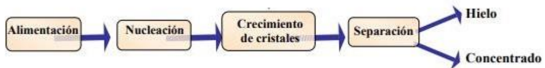
Figura 13: Esquema de las fases del proceso de concentración por congelación (29)
