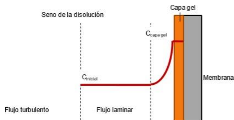
Figura 7: Fenómeno de polarización por concentración y formación capa gel
