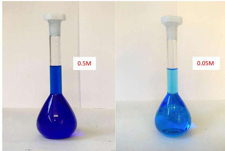
Figura 29. Disoluciones 0.5 M y 0.05 M de  $VOSO_4 \cdot xH_2O$ , suponiendo  $x=5$ .
