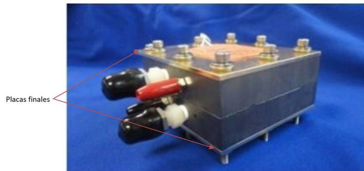
Figura 11. Celda electroquímica. Adaptado de (Fuel Cell Store, 2020)
