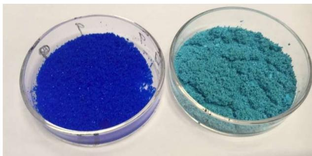
Figura 36. Muestra de  $\text{VOSO}_4 \cdot x\text{H}_2\text{O}$  antes del experimento de deshidratación (izquierda) y al finalizar (derecha).
