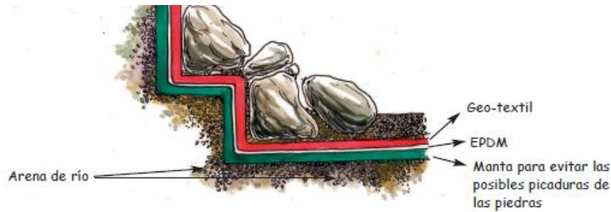
Figura 26. Detalle de impermeabilización para la charca de anfibios. Fuente: Manual CA Comunidad de Valencia
