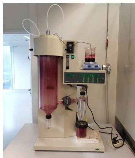
Figura 6: Esquema Mini Spray Dryer Buchi-290 (derecha) procesado de la atomización de jugo de remolacha (izquierda). Elaboración propia.
