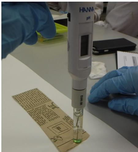
Figura 38: PH metro de sobremesa con sonda de superficie.
