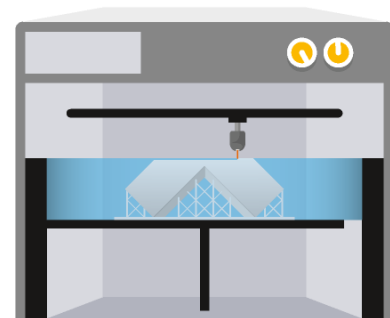
Ilustración 7. Tecnología de estereolitografía [7]
