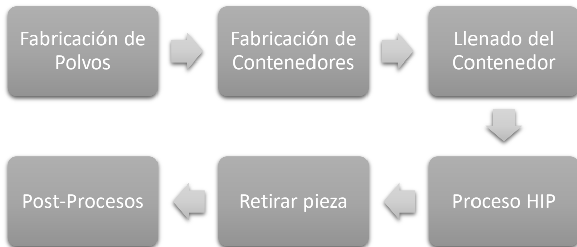
Ilustración 13. Etapas del proceso de fabricación HIP
