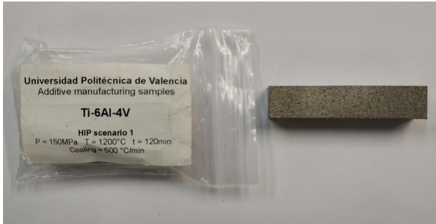
Ilustración 18. Muestra escenario 1, Ti6Al4V con EBM e HIP y enfriamiento de 500 °C/min
