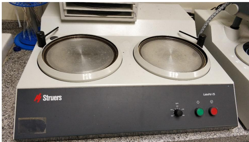
Ilustraci3n 34. Cintas de desbaste Labopol-25 del fabricante Struers
