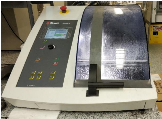
Ilustración 22. Tronzadora Struers Accutom 10
