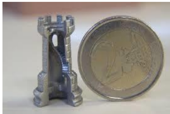
Ilustración 3. Ejemplo de pieza con geometría compleja y de tamaño muy pequeño fabricada mediante FA. [3]
