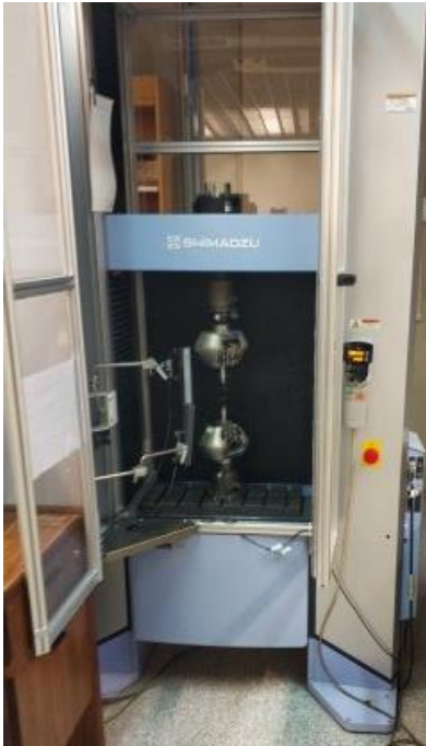
Ilustración 29. Maquina universal de ensayos Shimadzu
