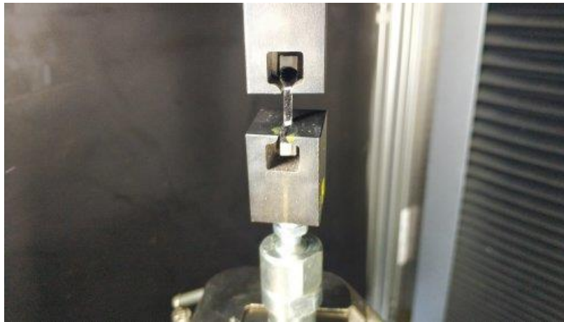
Ilustración 28. Probeta de sección rectangular preparada para ser ensayada.
