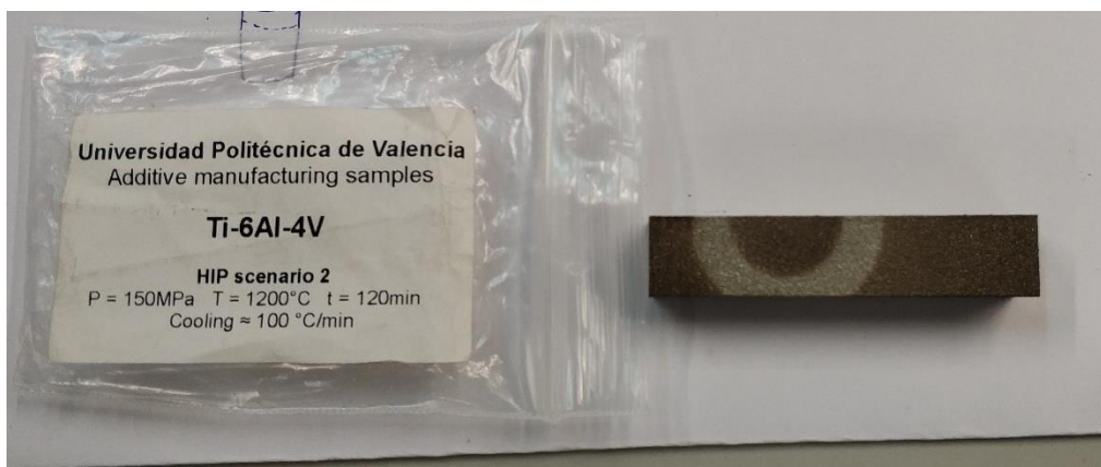
Ilustración 19. Muestra escenario 2, Ti6Al4V con EBM e HIP y enfriamiento de 100 °C/min
