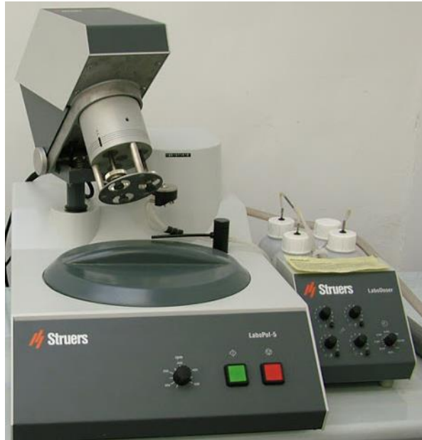
Ilustración 36. Máquina pulidora Struers LaboPol-5
