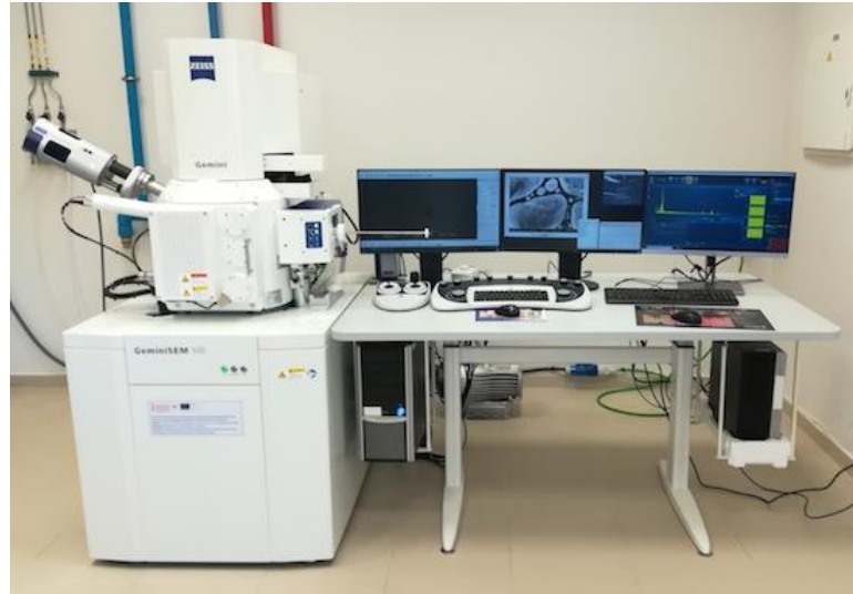
Ilustración 44. Microscopio Electrónico de Barrido de Emisión de Campo del fabricante Zeiss [21]
