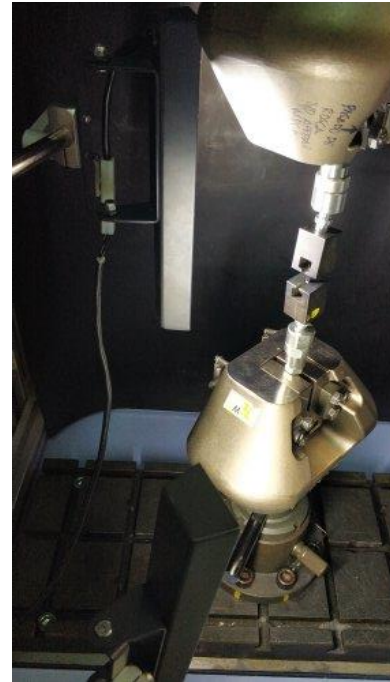
Ilustración 30. Montaje del ensayo de tracción.
