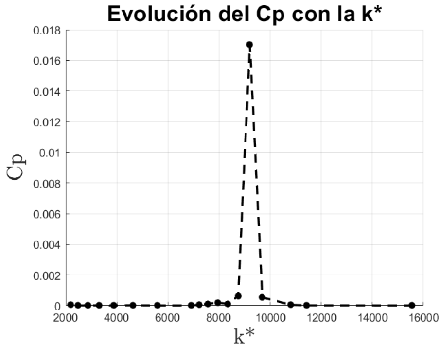
Figura 4.27: Evolución del coeficiente de potencias para un ratio de masas muy elevado.
