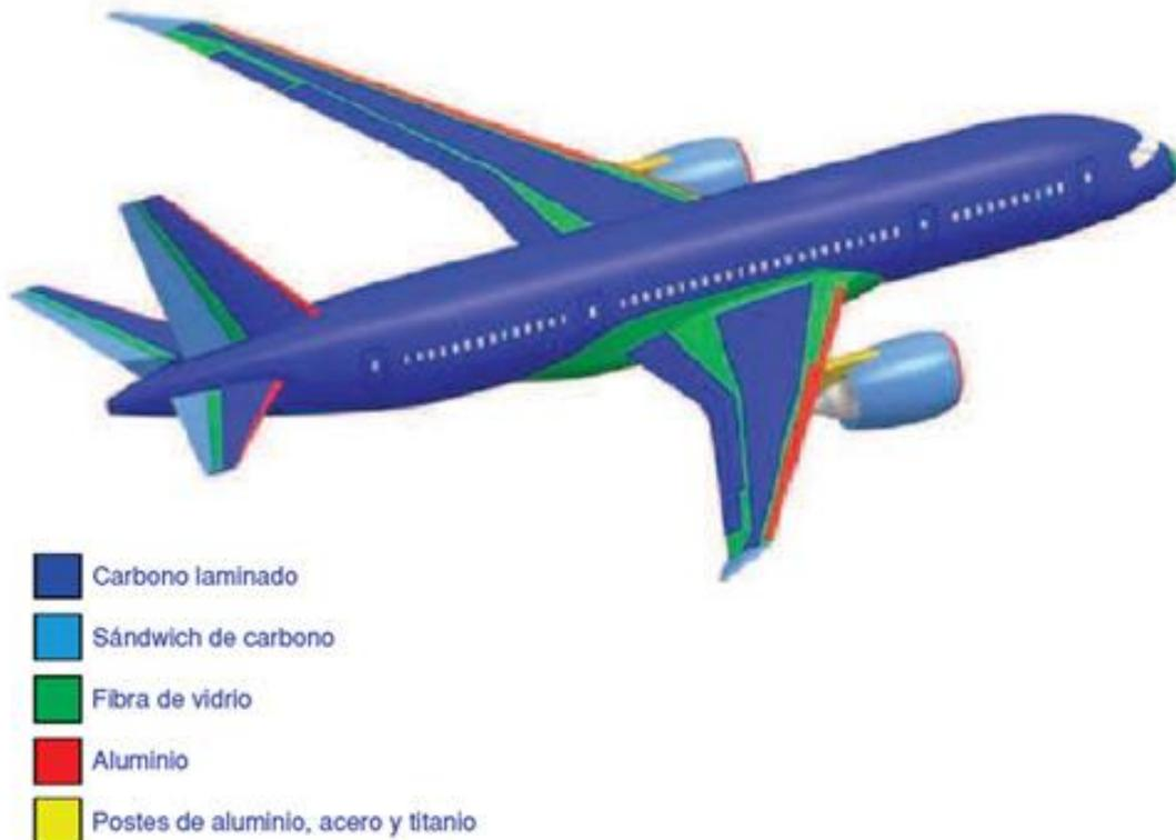
Figura 3.1. Materiales utilizados en un avión.
