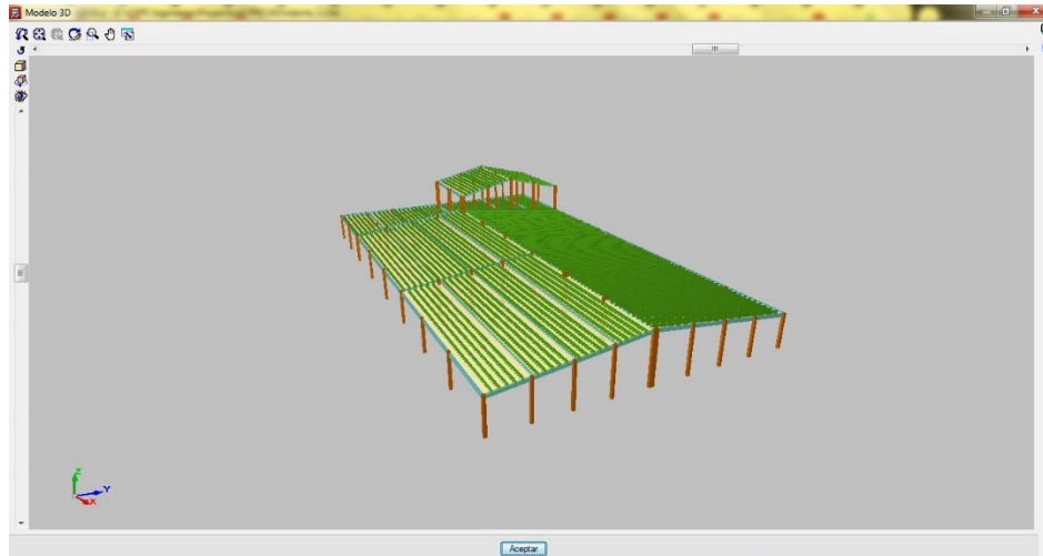
Imagen 3 Modelado de la estructura del edificio industrial
