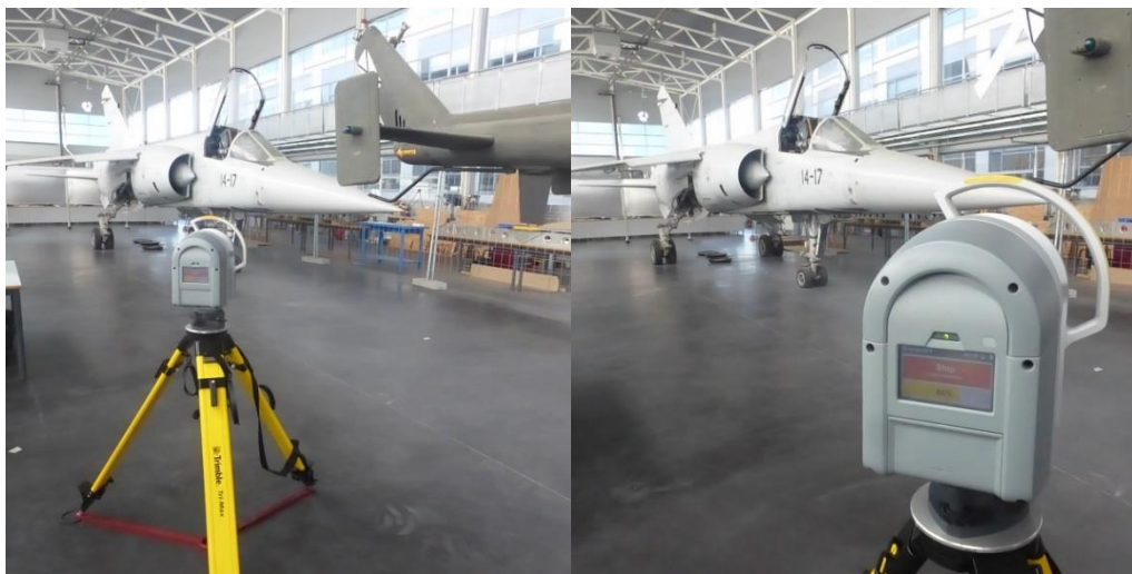
Figura 10.– Trimble TX6 escaneando, proceso de medida.
