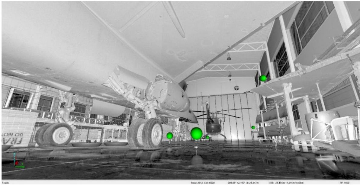
Figura 31.– Verificación de las esferas en Faro Scene , escaneo 11.
