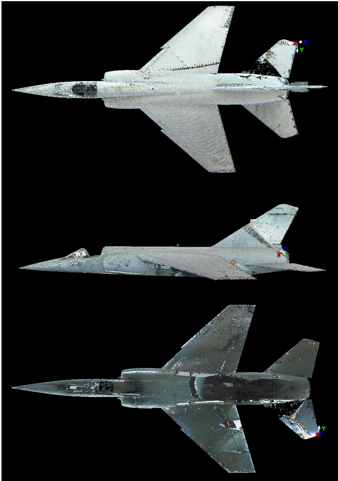
Figura 27.- Trimble TX6. Resultado final de la nube de puntos.
