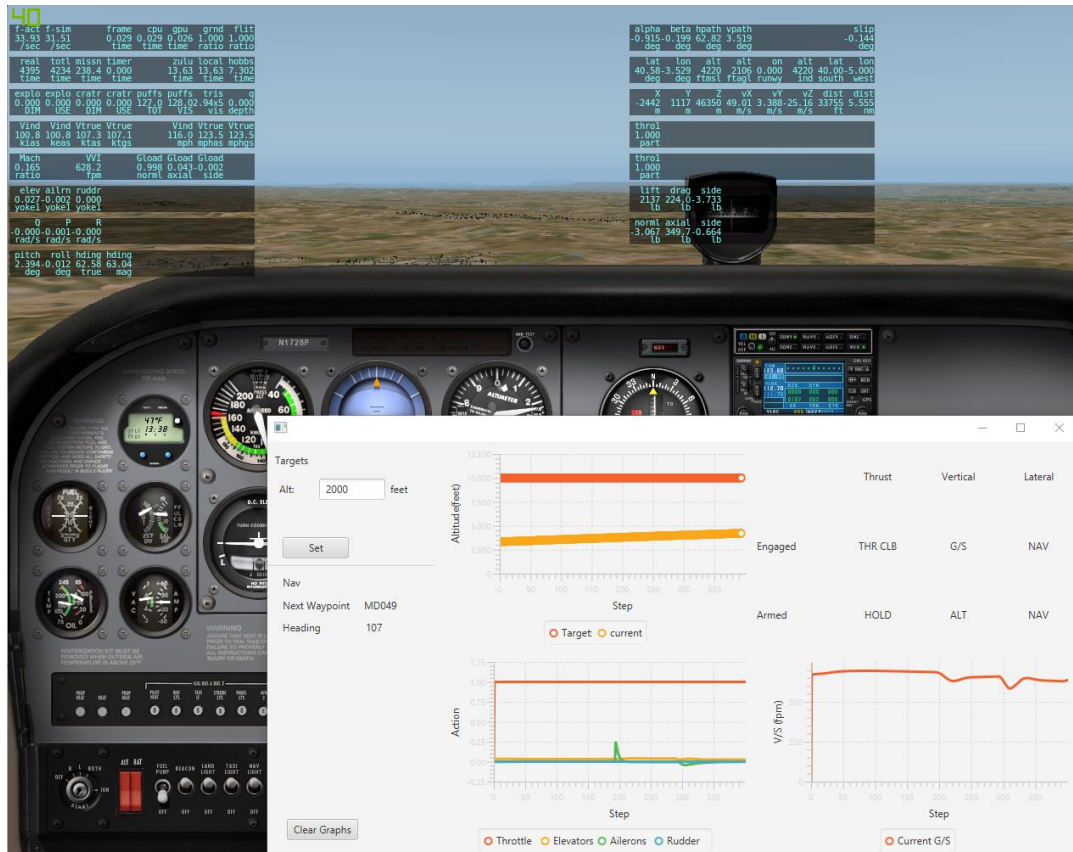
Ilustración 5.5 Interfaz gráfica del sistema de autopiloto
