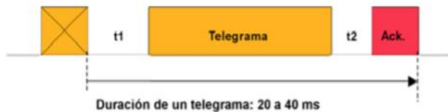
Figura 4.11 Tiempos de la transmisión en la estructura de telegramas
