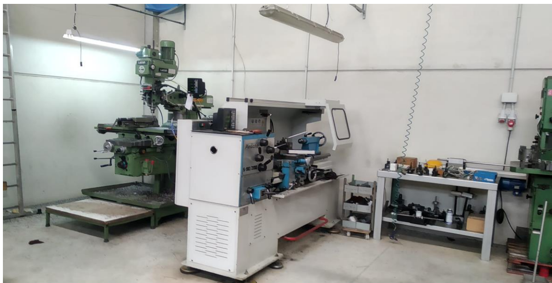
Figura 5.1 LAGUN FVT-4 detrás de un torno paralelo Pinacho S-90/260
