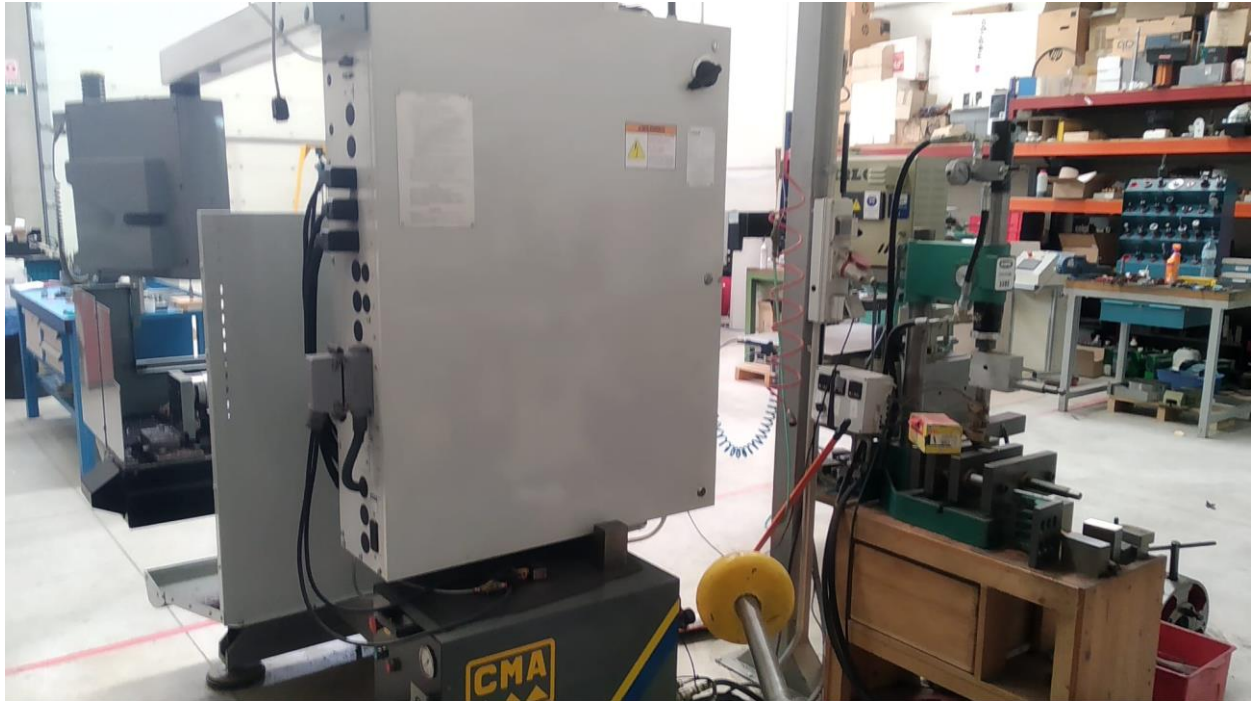
Figura 7.5 Cuadro de la Hass tm-1. El equipo que hay bajo es la unidad hidráulica de un brazo para roscar, no tiene nada que ver con la fresadora
