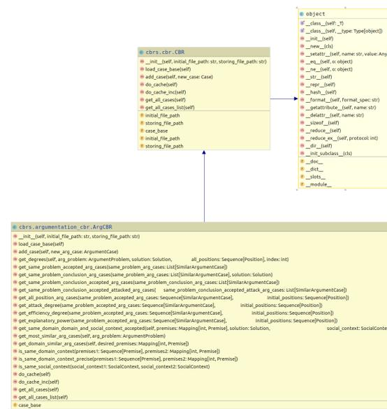
**Figura 5.2:** Esquema de dependencias del CBR de argumentación ofrecido por AgileJ
