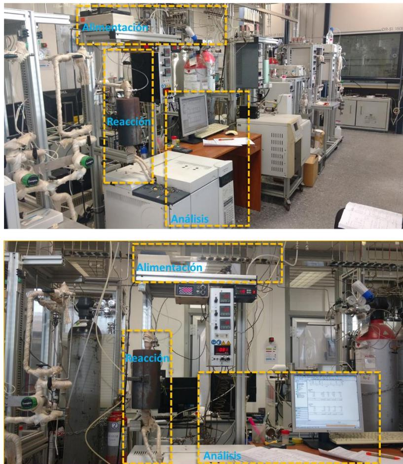
Figura 4. 1 Sistema de reacción para el estudio de la oxidación catalítica de hidrocarburos.
