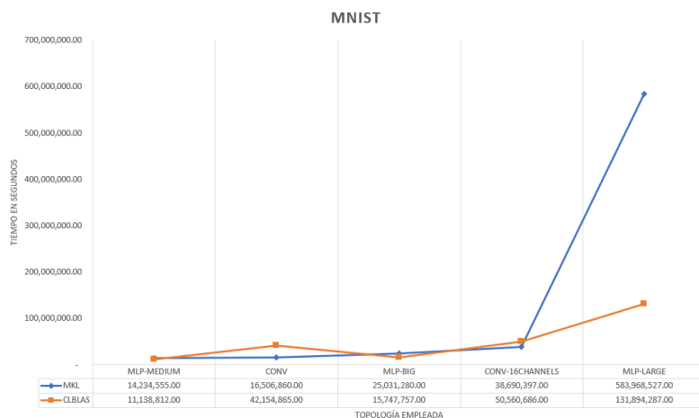
Figura 4.13: Comparativa del tiempo de entrenamiento en función de diferentes topologías sobre el conjunto de datos MNIST. Comparando la implementación MKL y CLBLAS.
