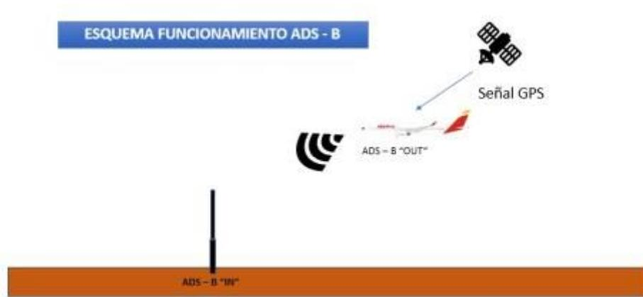
Ilustración 3. Esquema ADS-B.
