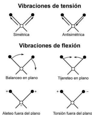
Figura 3.9. Tipos de vibraciones moleculares. NOTA: (+) indica un movimiento del plano de la página hacia el lector; (-) indica un movimiento del plano de la página alejándose del lector.
