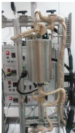
Figura 3.18. Fotografía de la zona de reacción del montaje experimental para los ensayos catalíticos a presión atmosférica.
