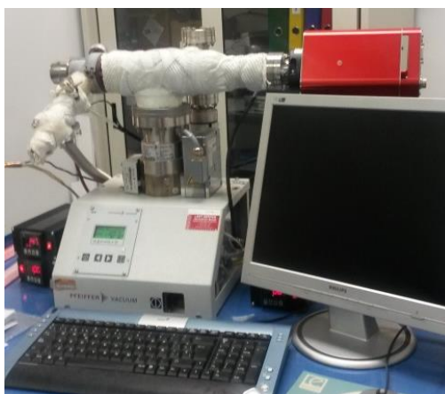
Figura 3.20. Fotografía de espectrómetro de masas Balzers (QMG 220M1, OmniStar™) empleado para los ensayos catalíticos a presión atmosférica.
