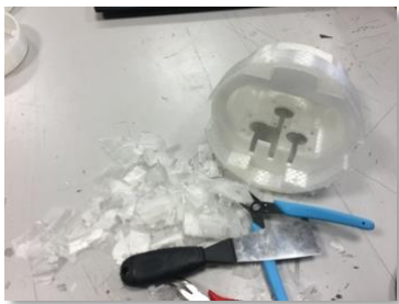
Figura 39: Detalle extracción de soporte en pieza PLA 3D. Elaboración propia.
