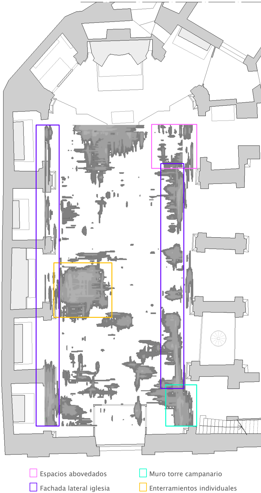
Figura IV.9. Compendio de resultados de la prospección geofísica.
