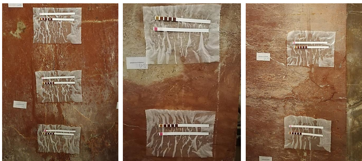
Figura V.30. Ensayo pulverización papeta: zócalo nueve (izq.), diez (centro) y once (der.).
