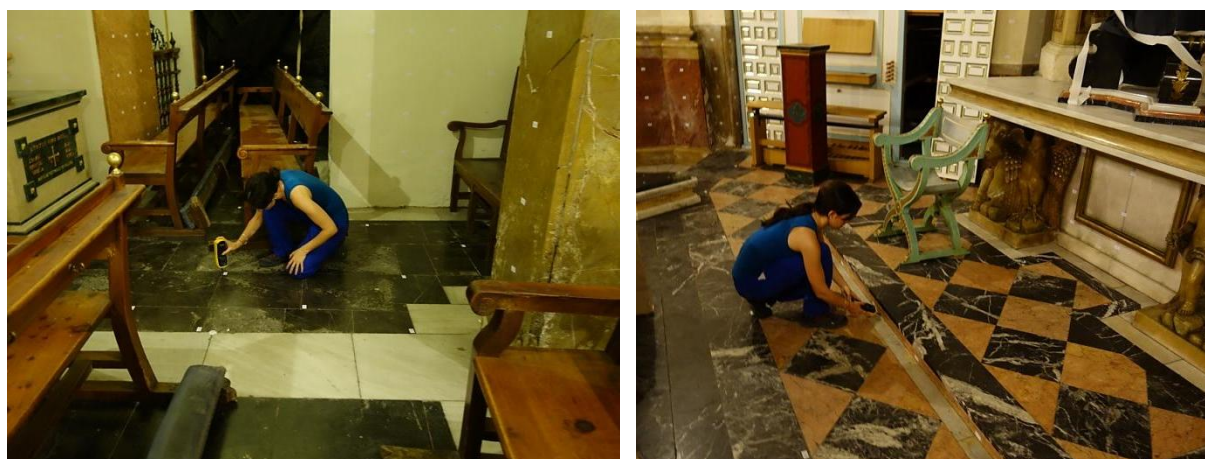
Figura V.22. Medición de la evaporación en la cabecera; pavimento general correspondiente al espacio absidal que conecta ambas iglesias (izq.), y enlosado del altar principal de la Capilla de la Comunión (der.).
