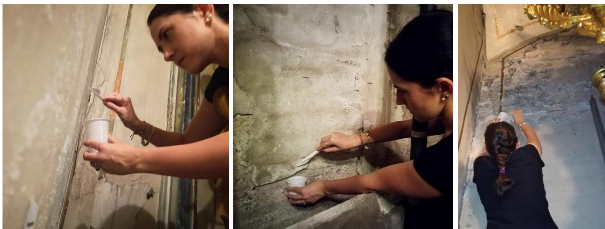
Figura V.32. Toma de muestras en los muros: intradós de la fachada principal en la capilla de la entrada (izq.) y lateral —interno— (centro) y de fondo (der.) en la capilla inmediata al altar principal.
