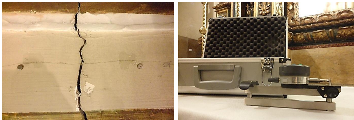
Figura V.37. Balizas de referencia (izq.). Calibrado del instrumento (der.).
