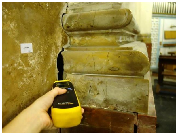
Figura V.20. Medición de la evaporación proveniente del interior del zócalo.
