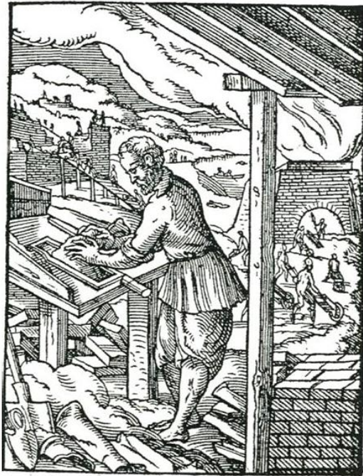
Figura IV.80. Elaboración artesanal del ladrillo en un taller medieval.
