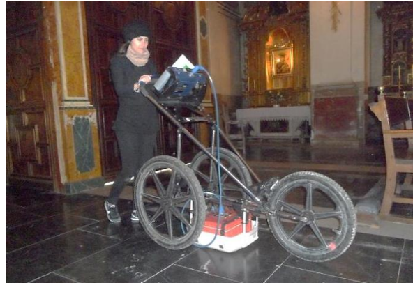
Figura IV.3. Toma de datos georadar.
