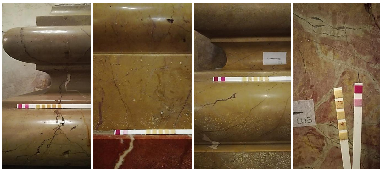
Figura V.29. Ensayo agua exudada: zócalo uno (1), cuatro (2), nueve (3) y catorce (4).
