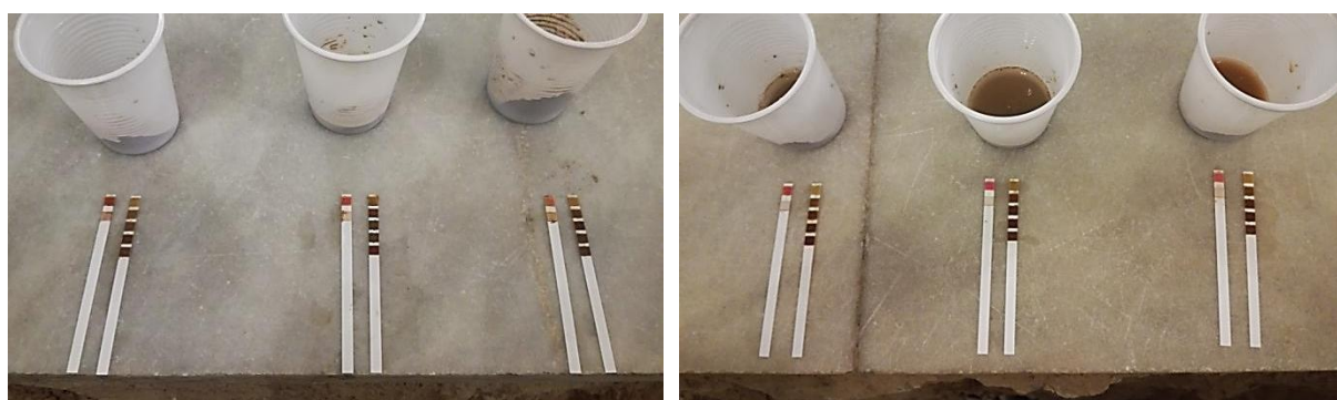
Figura V.34. Ensayo disolución: zona pila bautismal (izq.) y nexo central entre iglesias (der.).
