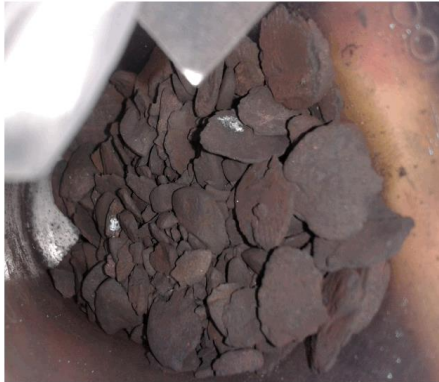
Figura 7-13 Trazas de Cu en magnetita en ensayo QPbis2.
