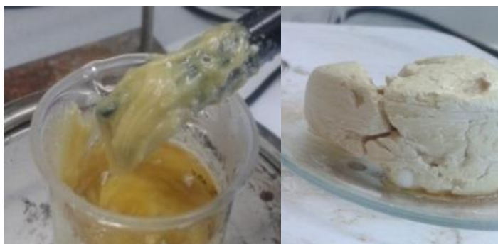
Figura 6-7 Pasta formada cuando se ajusta el pH (izquierda) y posterior a la solidificación al cabo de 17 h (derecha).
