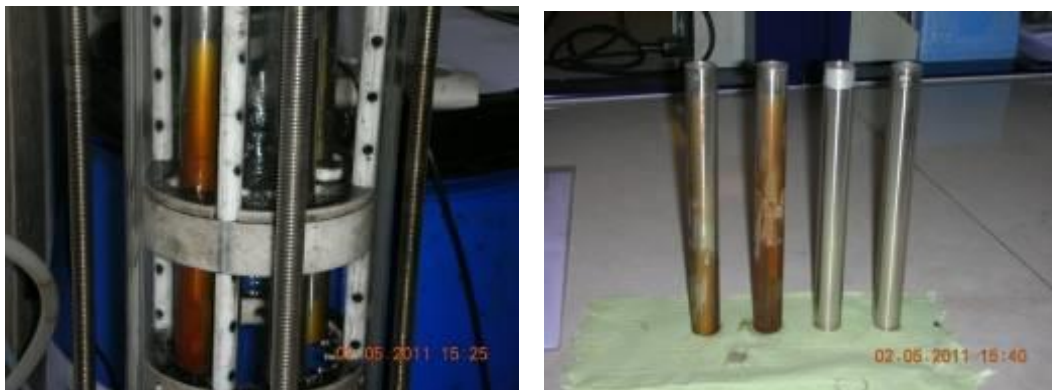
Figura 4-51 Tubos de inconel del ensayo D51 insertados (izda); (dcha) tubo inconel del mismo ensayo al final del descobreado (6h).
