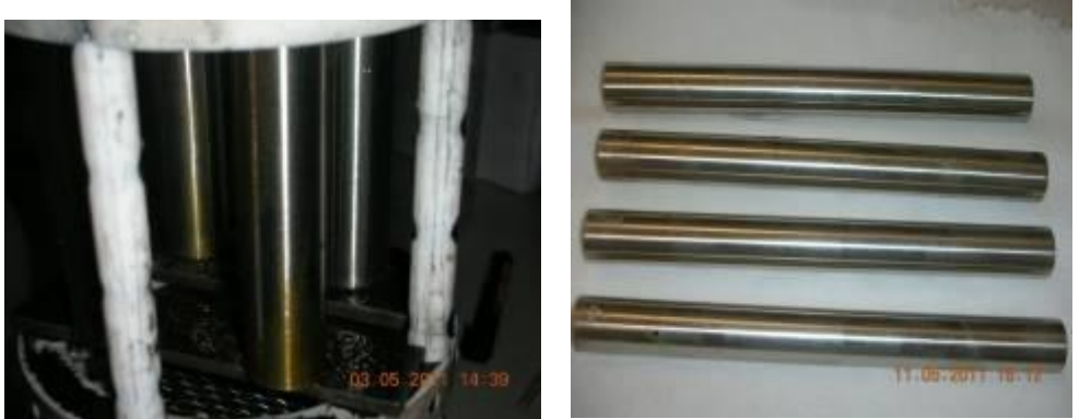
Figura 4-52 Tubos de inonel del ensayo D52 en contacto con placas de acero al carbono(izda); tubos de inonel ensayo D53 después de 8 h de descubreado(dcha).
