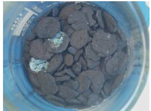
Figura 7-3 Trazas de Cu sobre depósitos de magnetita
