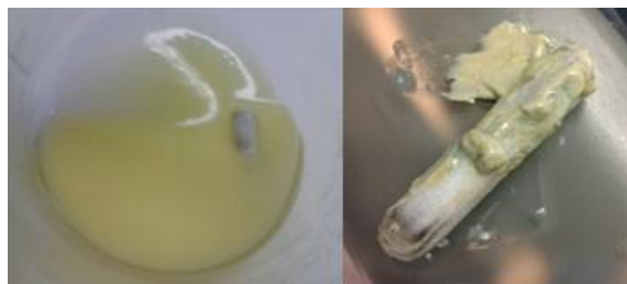
Figura 6-1 Ensayos de reproducción en laboratorio de la formación del complejo Cu-DBTU
