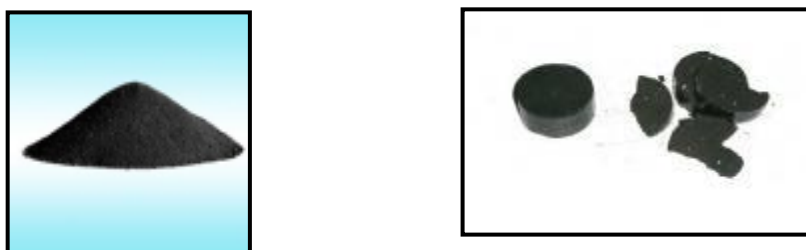
Figura 3-22 Magnetita en polvo (izda);pastillas antes y después de triturar (dcha).
