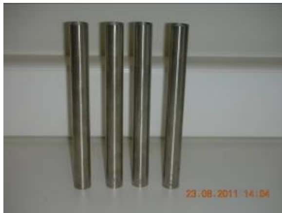
Figura 4-57 Tubos en inconel del ensayo D64 al final de la fase de descubreado fraccionado
