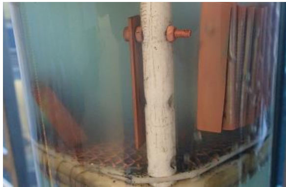
Figura 7-8 Estado de algunos componentes de la maqueta al final de la fase ácida del ensayo QPbis2.
