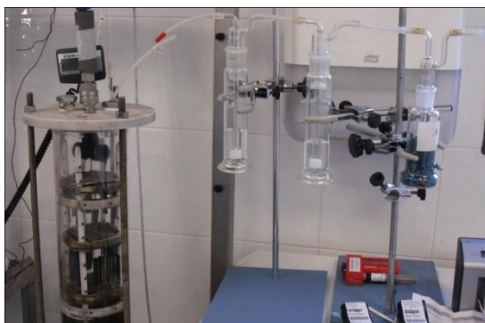
Figura 3-16. Sistema de muestreo de efluentes gaseosos.
