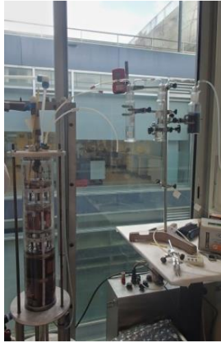
Figura 7-9 Montaje para la serie de aclarados de la fase ácida.
